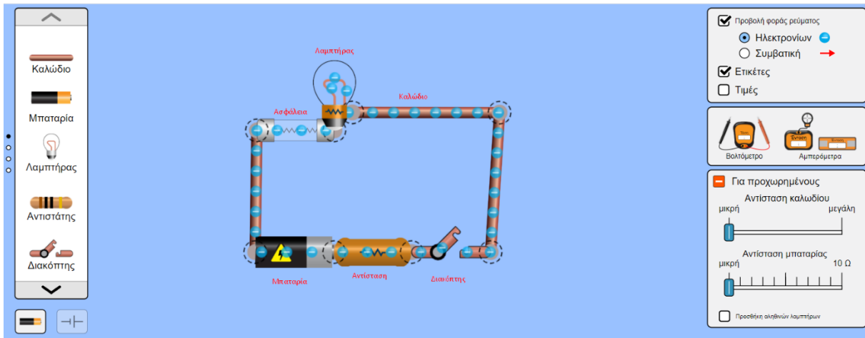
Εικόνα 4.4: Ηλεκτρικό κύκλωμα στο εικονικό εργαστήριο της προσομοίωσης PhET με ανοικτό διακόπτη (δεν ρέει ηλεκτρικό ρεύμα / ανοικτοκύκλωμα).
