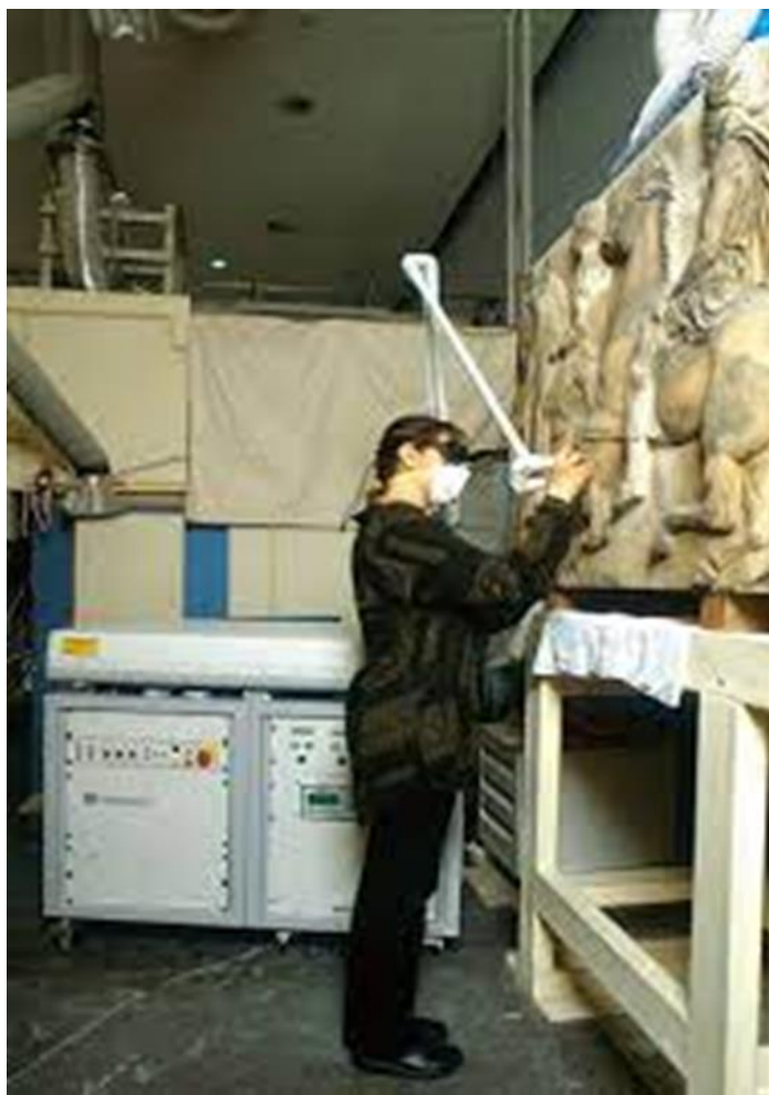
Εικ.24: Καθαρισμός της δυτικής ζωφόρου στο εργαστήριο με χρήση ακτίνων Λείζερ. ( Εύρεση εικόνας από google, Acropolis Educational Material).
