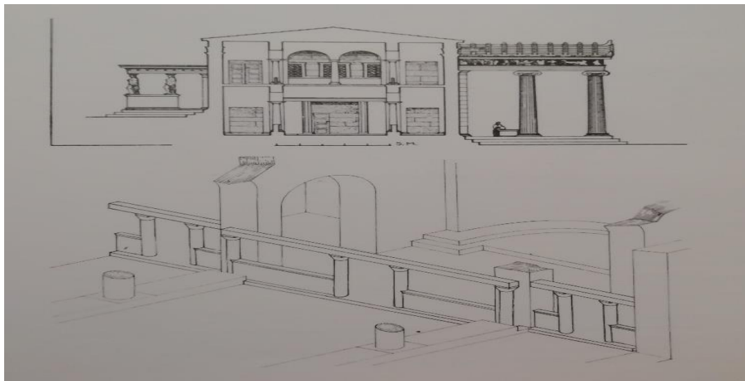
Εικ.7: Εγκάρσια τομή του χριστιανικού Ερεχθείου με όψη προς δυσμάς. Διακρίνεται η άρθρωση του εσωτερικού χώρου σε τρίκλιτη βασιλική με εξώστες. Κάτω η κάτοψη της οργάνωσης του φράγματος του πρεσβυτερίου. ( βλ. του κ. Γρηγορίου Α. Πουλημένου, "ΑΠΟ ΤΟΝ ΧΡΙΣΤΙΑΝΙΚΟ ΠΑΡΘΕΝΩΝΑ ΣΤΟΝ ΛΥΣΑΝΑΡΟ ΚΑΥΤΑΝΤΖΟΓΛΟΥ",63, ΑΘΗΝΑ 2006).
