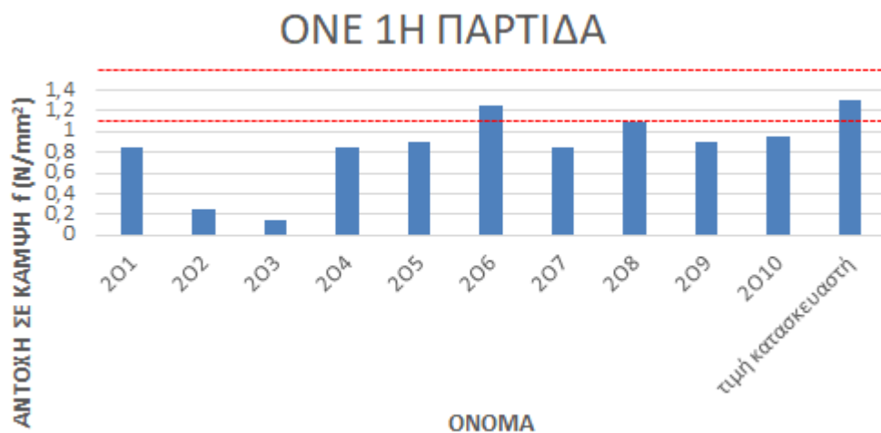
Διάγραμμα 5.3.53. Διάγραμμα καμπτικής αντοχής f της 1 ης παρτίδας Marmocret One (με κόκκινες διακεκομμένες τα όρια του κατασκευαστή)
