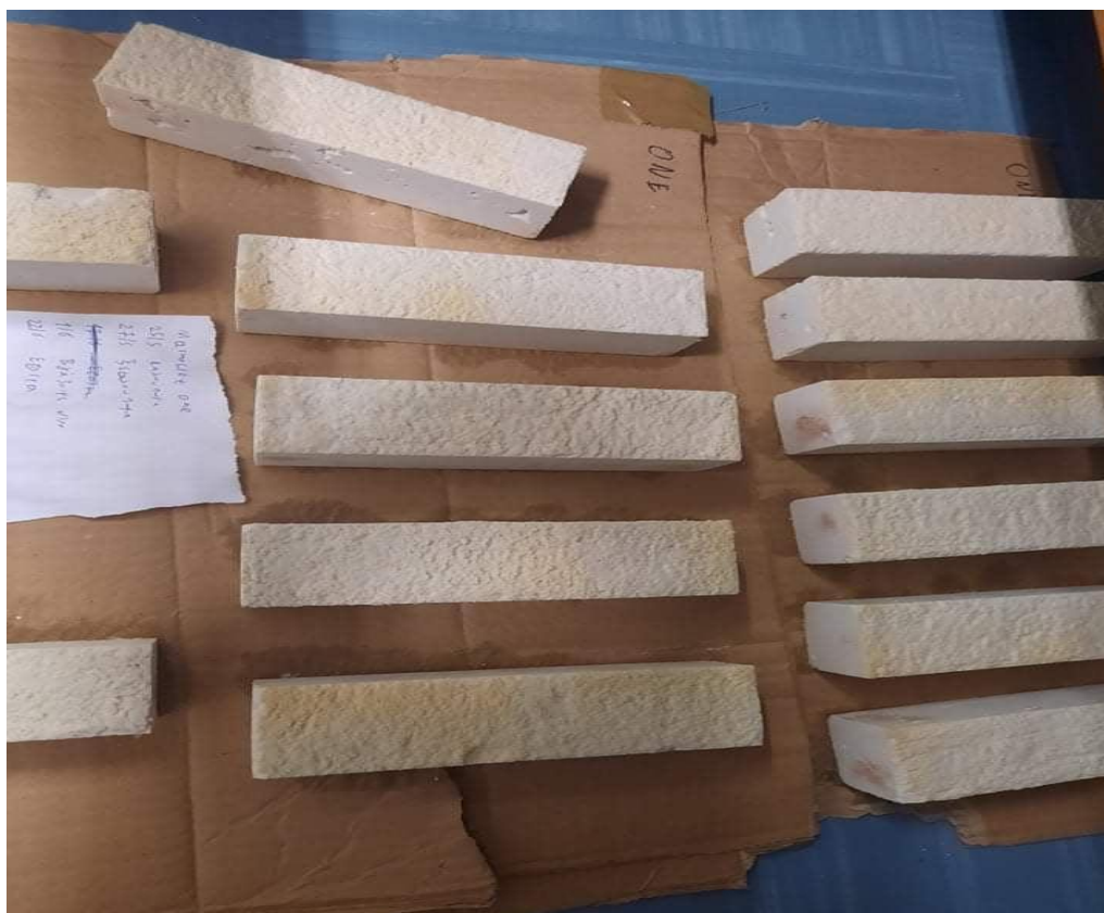
Εικόνα 4.16 Δοκίμια Marmocret one εκτός καλουπιού
