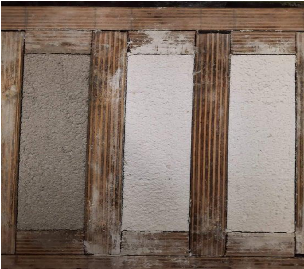
Εικόνα 4.21 Δοκίμια Marmocret base, one, fine (που δεν μπήκαν στο νερό) σε καλούπι
