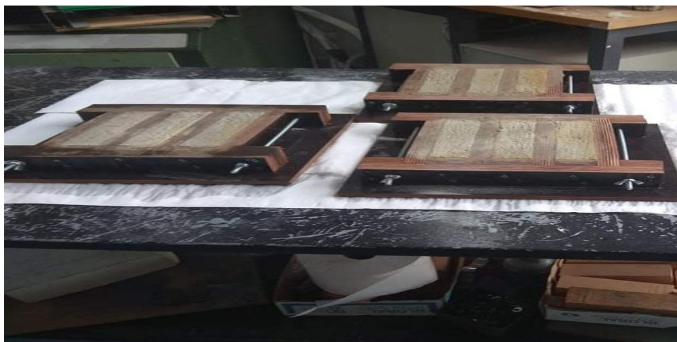
Εικόνα 4.9 Δοκίμια Marmocret base σε καλούπια
