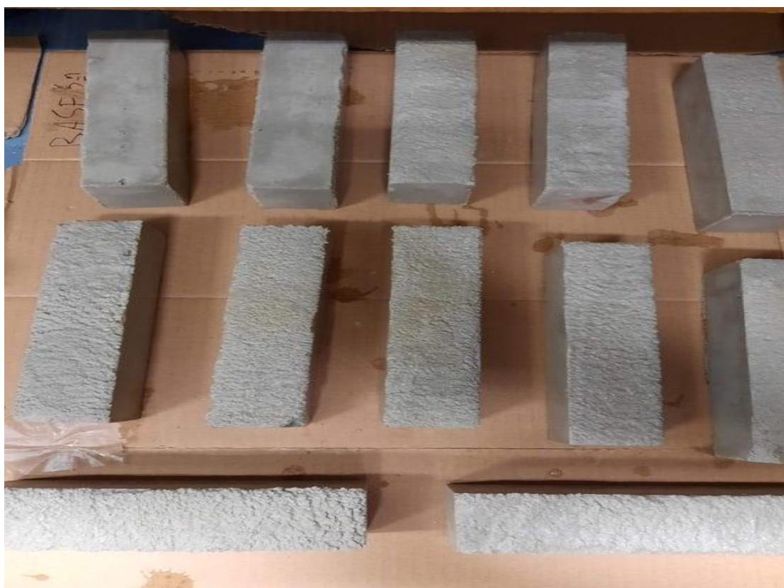
Εικόνα 4.11 Δοκίμια Marmocret base εκτός καλουπιού
