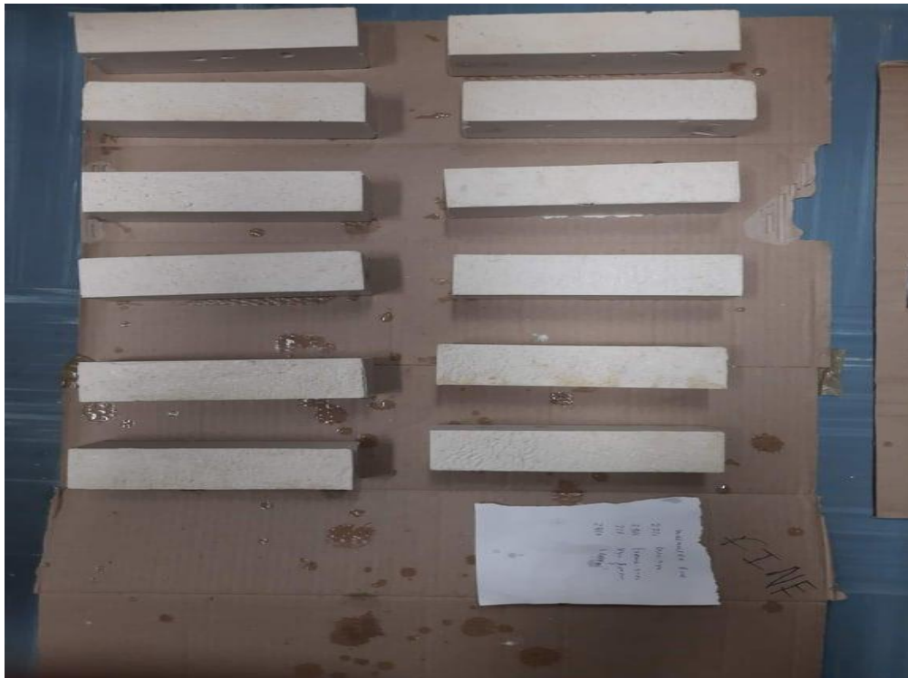
Εικόνα 4.14 Δοκίμια Μarmocret fine εκτός καλούπιού
