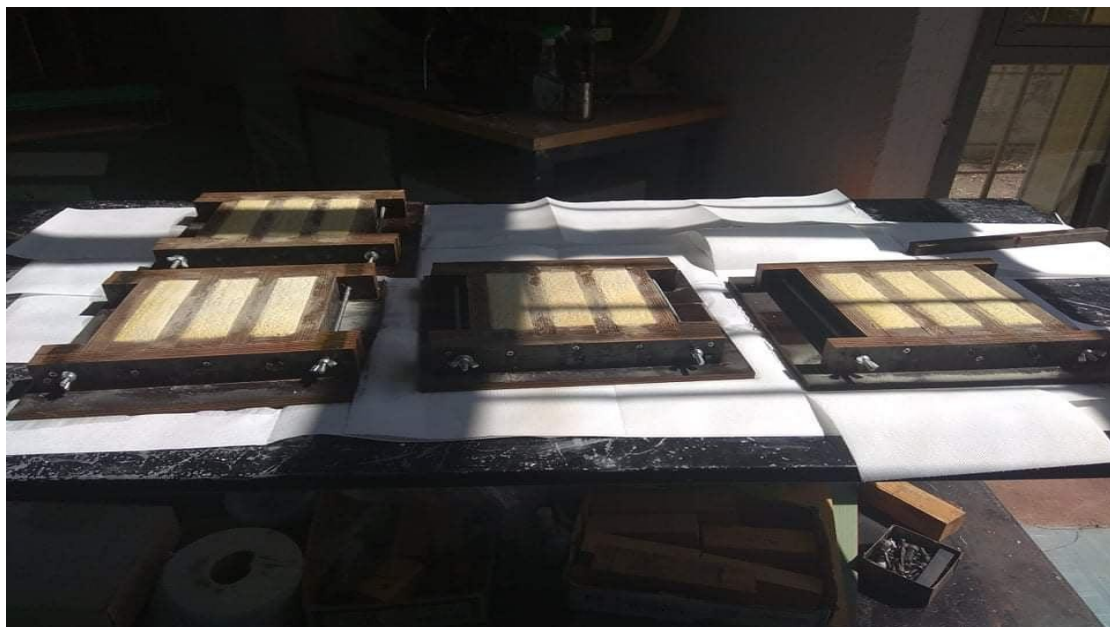
Εικόνα 4.15 Δοκίμια Μarmocret one σε καλούπια
