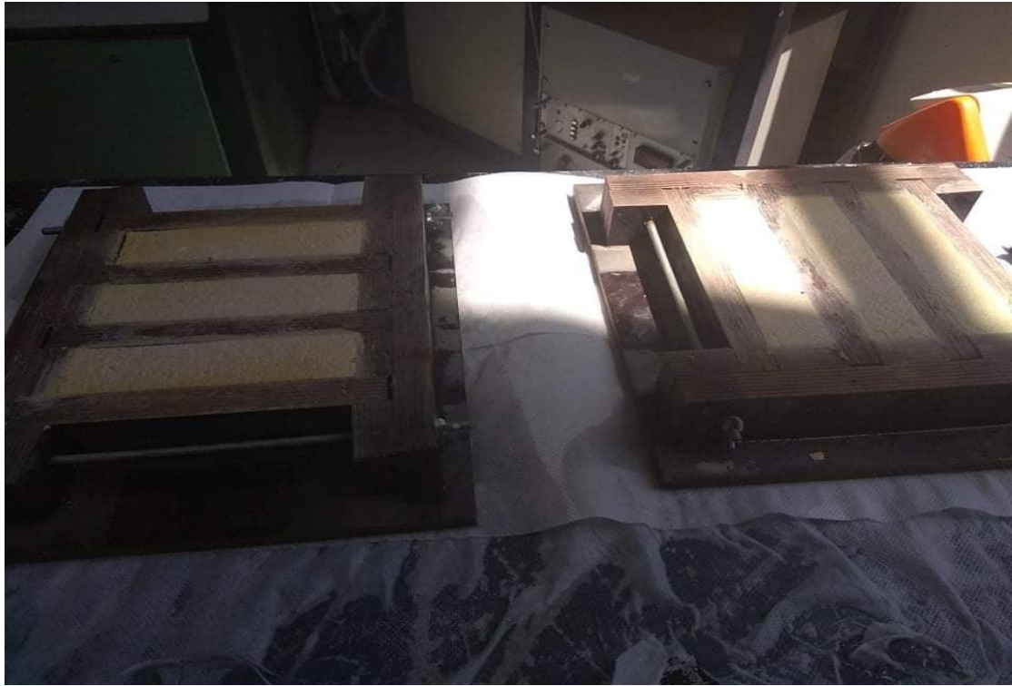
Εικόνα 4.12 Δοκίμια Marmocret fine σε καλούπι
