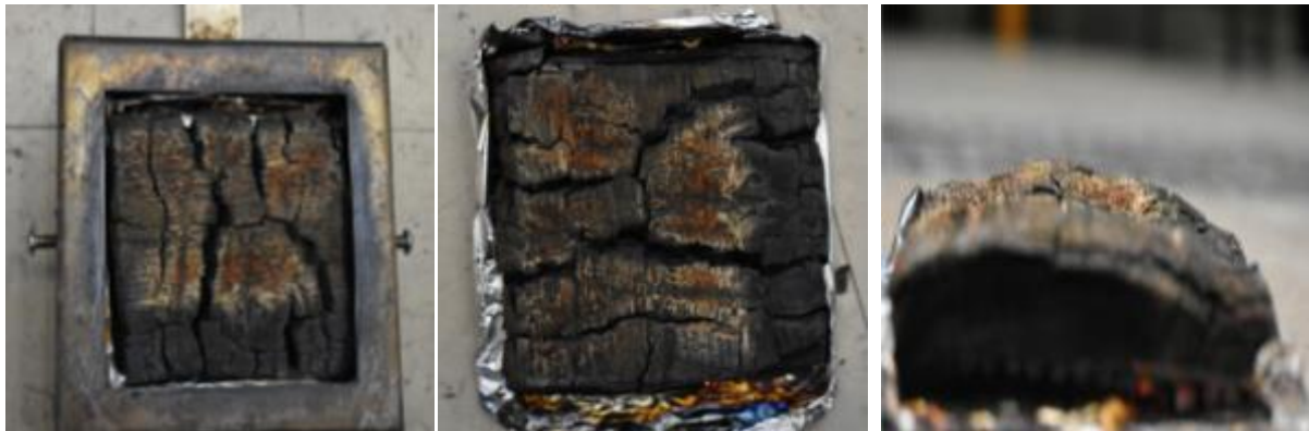
Εικόνα 22: Υπολείμματα δοκιμίου Πεύκου μετά από δοκιμή σε 50 \text{ kW/m}^2 .
