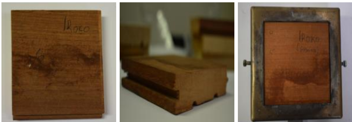
Εικόνα 15: Διαδικασία προετοιμασίας δοκιμίων IROKO.
