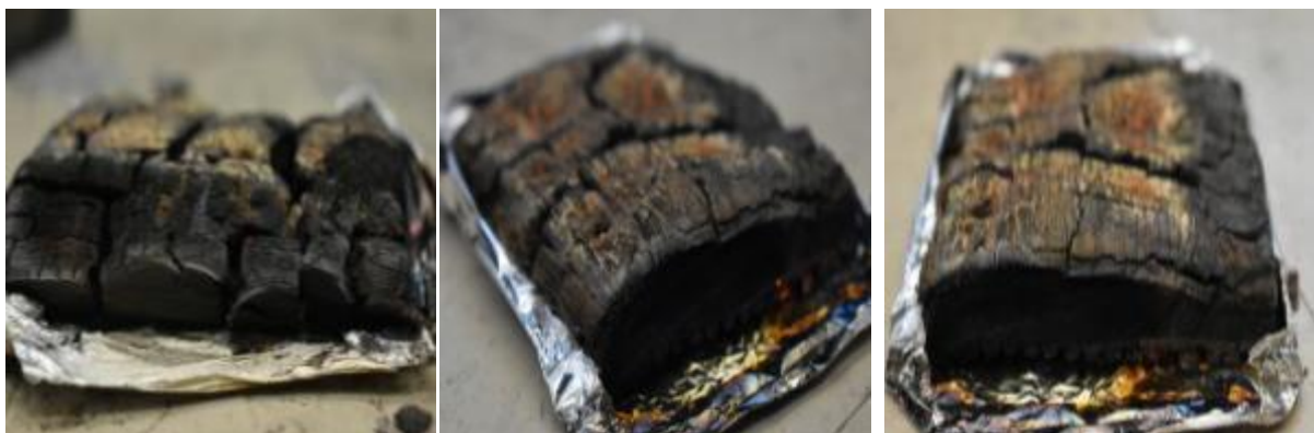
Εικόνα 24: Παραμόρφωση υπολειμμάτων δοκιμίου Πεύκου ( 75 \text{ kW/m}^2 ).
