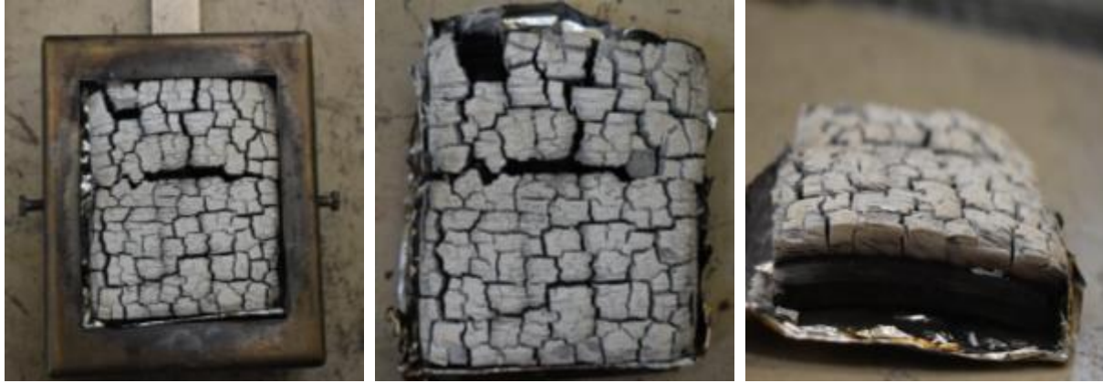
Εικόνα 19: Υπολείμματα δοκιμίων Ιρόκο μετά από δοκιμή σε 50 \text{ kW/m}^2 .
