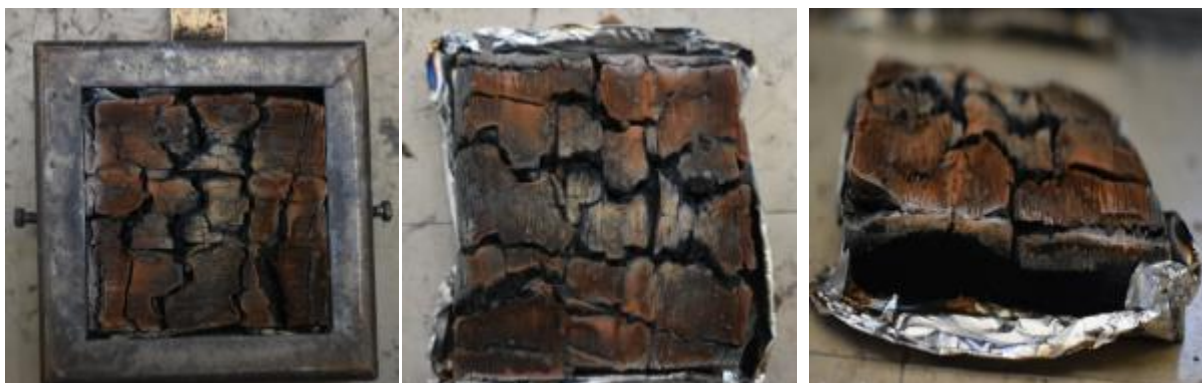
Εικόνα 26: Υπολείμματα Έλατου μετά από δοκιμή σε 75\text{ kW/m}^2 .
