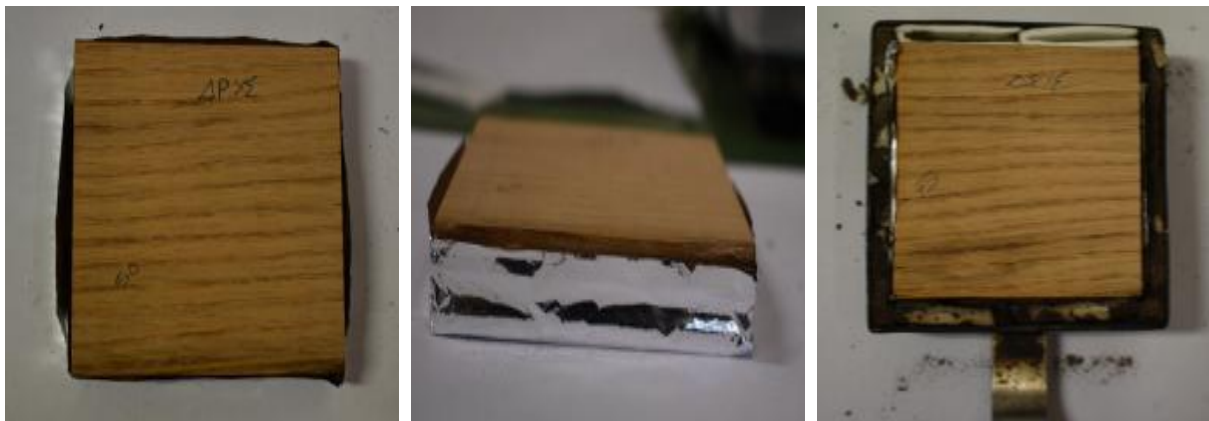
Εικόνα 12: Πλευρική κάλυψη των δοκιμίων δρυός με φύλλο αλουμινίου και τοποθέτηση στην ειδική βάση εισαγωγής στο Θερμιδόμετρο Κώνου.
