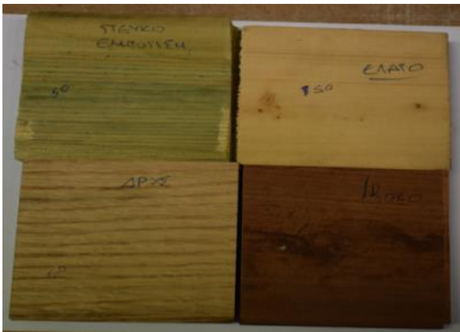
Εικόνα 10: Είδη ξύλου προς δοκιμή (Πεύκο, Έλατο, Δρυς, Ιρόκο).
