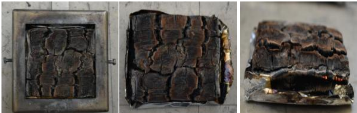
Εικόνα 25: Υπολείμματα Έλατου μετά από δοκιμή σε 50\text{ kW/m}^2
