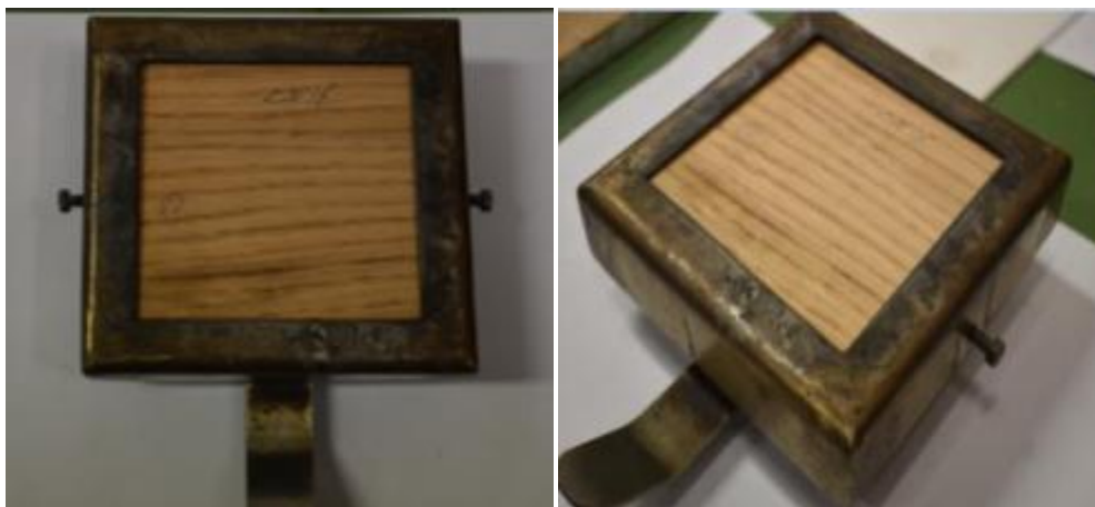
Εικόνα 13: Τοποθέτηση δοκιμίων Δρυός στη βάση - έλεγχος διαστάσεων.
