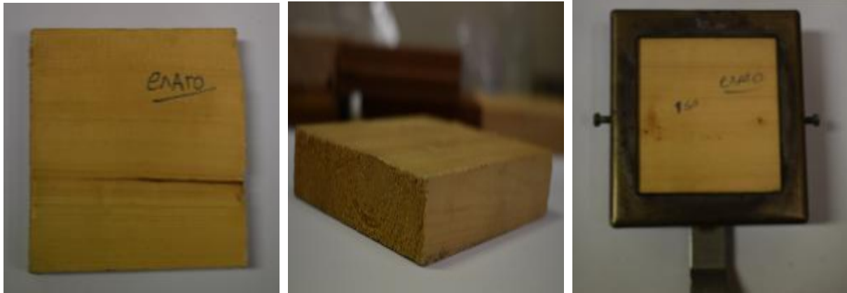
Εικόνα 14: Διαδικασία προετοιμασίας δοκιμίων Ελάτης.
