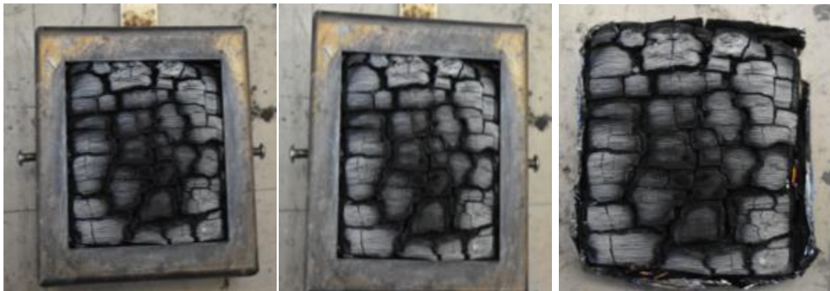
Εικόνα 17: Υπολείμματα Δρυός μετά από τη δοκιμή σε 50 \text{ kW/m}^2
