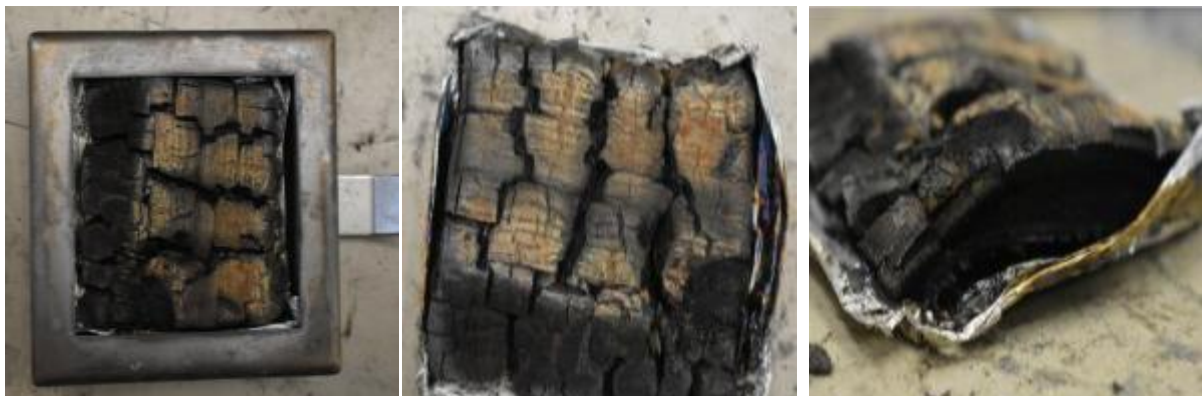
Εικόνα 23: Υπολείμματα δοκιμίου Πεύκου μετά από δοκιμή σε 75 \text{ kW/m}^2 .
