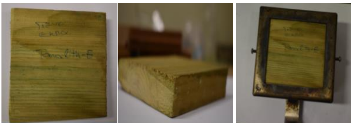
Εικόνα 16: Διαδικασία προετοιμασίας δοκιμίων Πεύκου.
