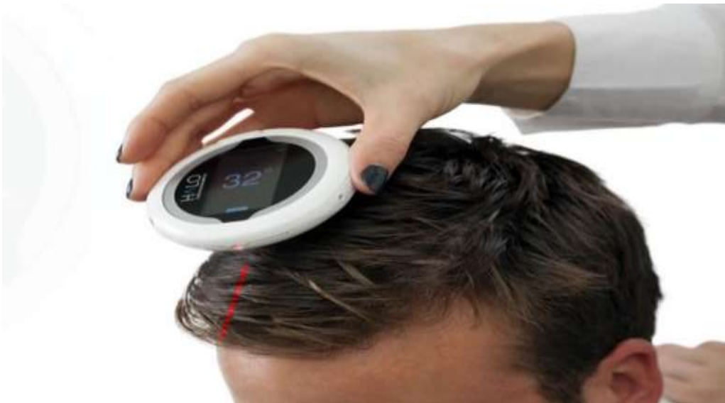
ΕΙΚΟΝΑ 3. Ηλεκτρονικό γωνιόμετρο HALO
