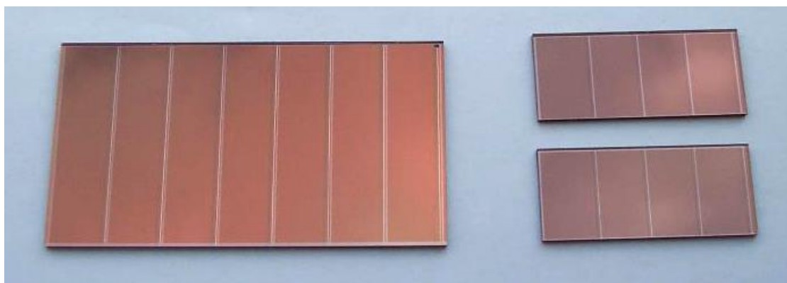
Εικόνα 4.4 : Φωτοβολταϊκά στοιχεία άμορφου πυριτίου (18).
