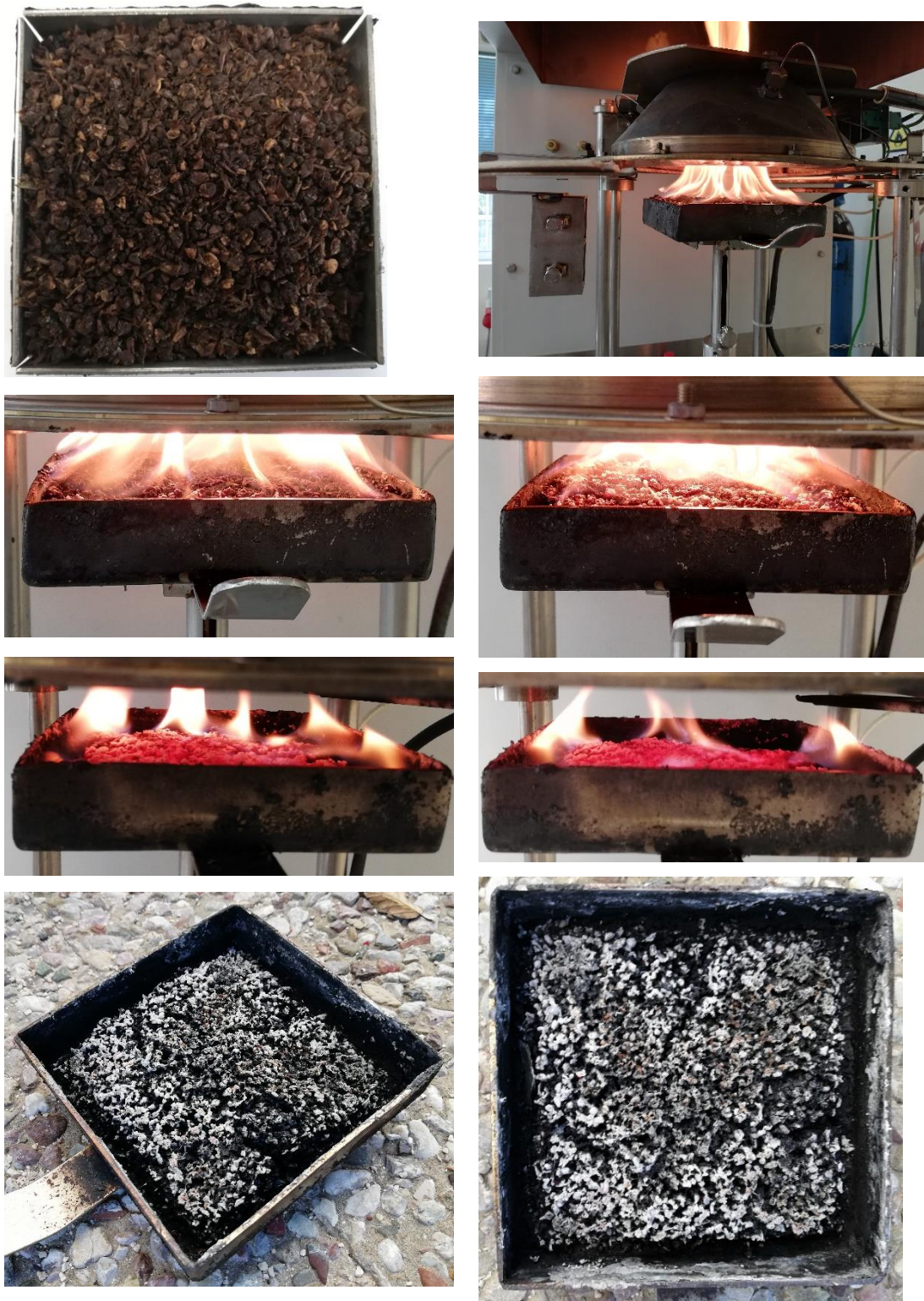
Εικόνα 4.8 Χαρακτηριστικά στιγμιότυπα πριν και μετά την καύση εργαστηριακού ξηρού ελαιοπυρήνα (ξυλοπυρήνας)
