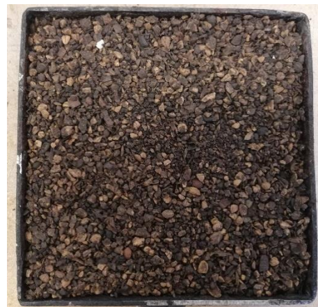
Παραγόμενος βιομηχανικός ξηρός ελαιοπυρήνας (ξυλοπυρήνας)
