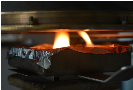
Εικόνα 4.9 Χαρακτηριστικά στιγμιότυπα πριν και μετά την καύση εργαστηριακού αλλοιωμένου ξηρού ελαιοπυρήνα (ξυλοπυρήνας)
