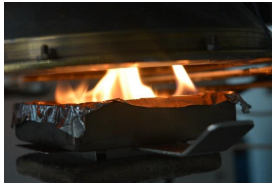
Εικόνα 4.9 Χαρακτηριστικά στιγμιότυπα πριν και μετά την καύση εργαστηριακού αλλοιωμένου ξηρού ελαιοπυρήνα (ξυλοπυρήνας)
