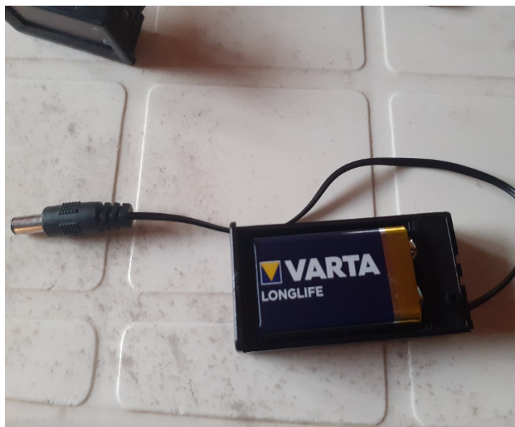
Εικόνα 60 : Αλκαλική μπαταρία 9 Volt
