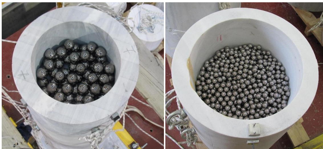
Εικ. 64 Προστασία μνημείων από τον σεισμό με την χρήση αποσβεστήρα σωματιδίων σε σπονδυλωτούς κίονες ( Α. Παπαλού)
