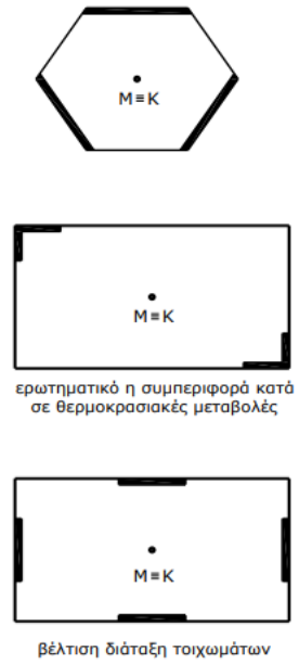
Εικ. 13 Μορφολογία κτιρίου σε κάτοψη – Κατανομή μάζας και δυσκαμψίας
