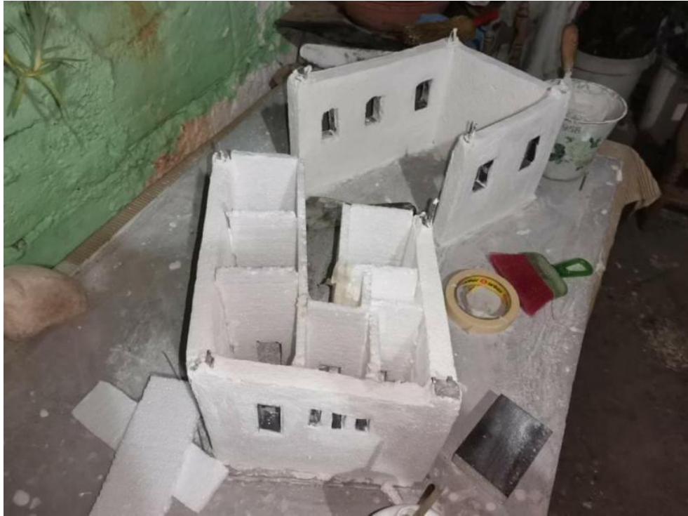
Εικόνα 26: Διαχωρισμός δωματίων ισογείου από φελιζόλ.
