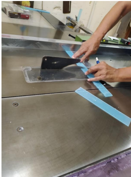
Εικόνα 32: Διαδικασία κοπής μεγάλων κομματιών Plexiglas από έμπειρο τεχνίτη.
