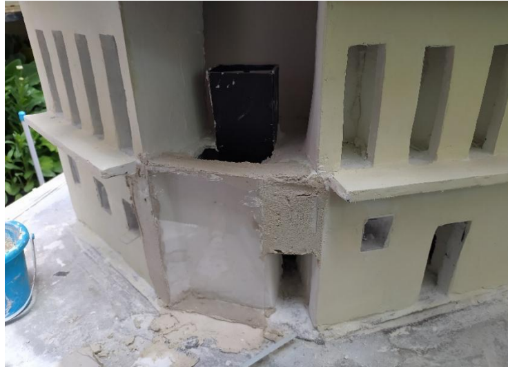
Εικόνα 35: Πίσω όψη υπό κατασκευή. Ανοίγματα από ζελατίνη.
