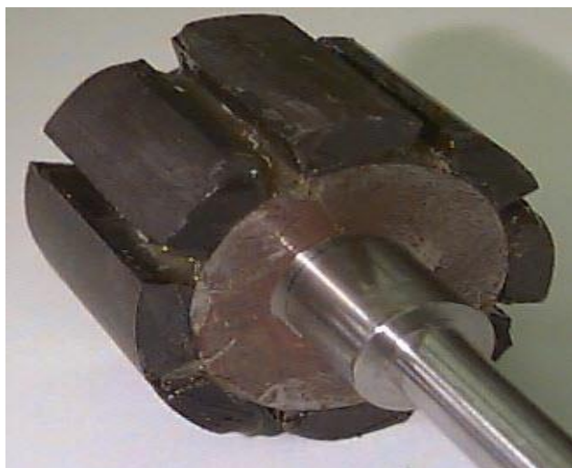
Σχήμα 3.3: Δρομέας κινητήρα BLDC αποτελούμενο από μόνιμους μαγνήτες
