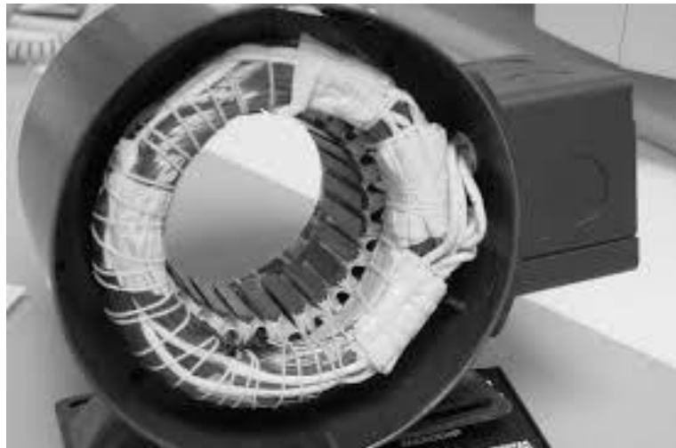
Σχήμα 3.1: Στάτης μηχανής brushless, όπου φαίνονται οι εγκοπές στην εσωτερική περιφέρεια του στάτη οι πυρήνες και τα τυλίγματα
