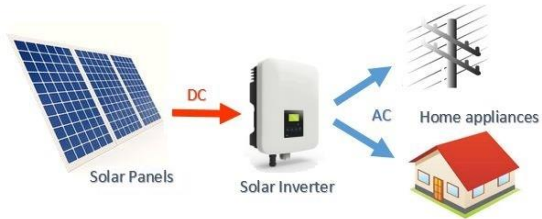
Εικόνα 1.24.: Χρήση του αντιστροφέα σε φωτοβολταϊκά συστήματα. [21]
