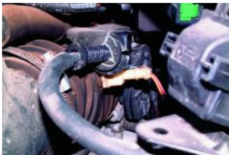
Εικόνα 2.06: Αισθητήρας θερμοκρασίας εισερχομένου αέρα στην πολλαπλή εισαγωγή. Συνήθως βρίσκεται αμέσως μετά από το φίλτρο αέρα στον αεραγωγό, που οδηγεί από το φίλτρο αέρα στην πολλαπλή εισαγωγή [3].
