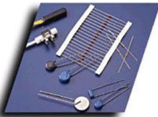
Εικόνα 2.02: Τυπικά θερμίστορ του εμπορίου της εταιρείας Therm-O-Disk [4].
