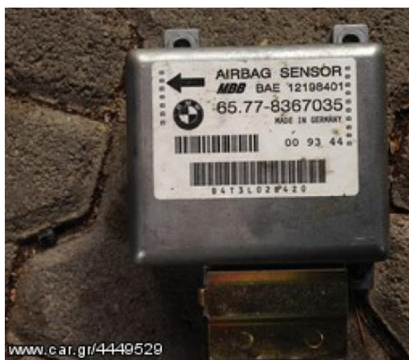
Εικόνα 5.07: Αισθητήρας για αερόσακο [10].
