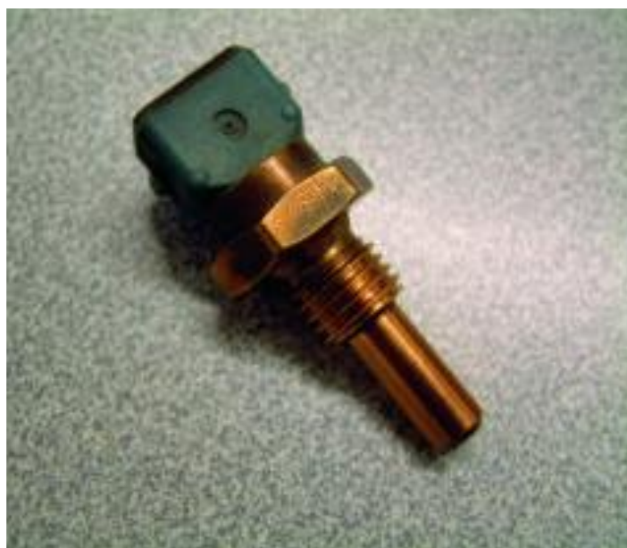
Εικόνα 2.03: Αισθητήρας θερμοκρασίας ψυκτικού υγρού [3].
