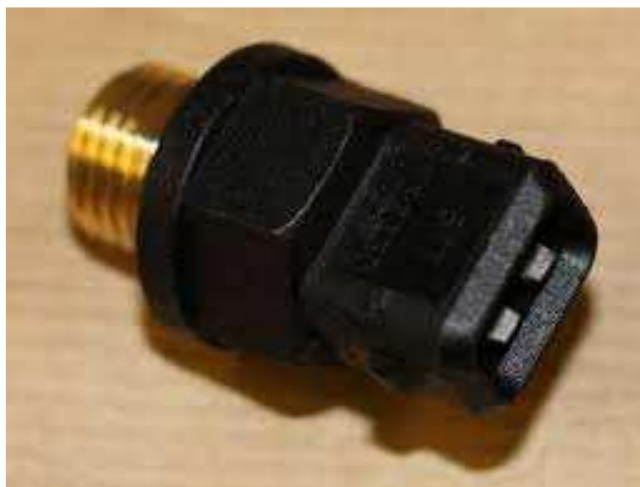
Εικόνα 2.05: Αισθητήρας θερμοκρασίας καυσίμου [1].
