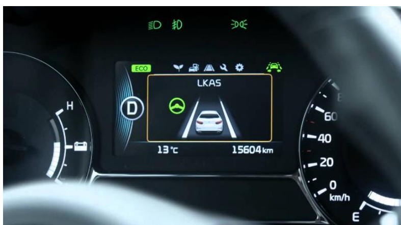
Εικόνα 5.05: Σύστημα διαρκείας παρακολούθησης εντός της λωρίδας κυκλοφορίας.
