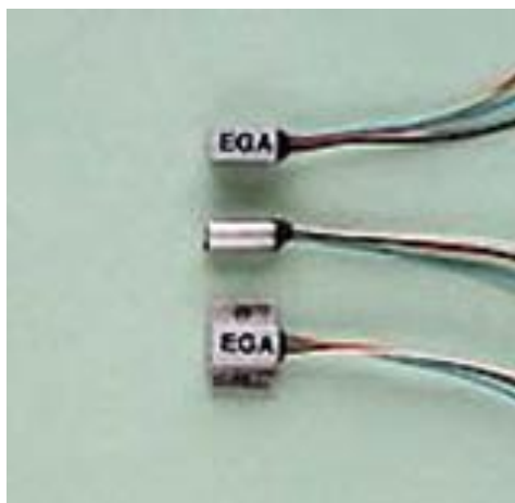
Εικόνα 4.01: Επιταχυνσιόμετρο σειράς EGA της εταιρείας Entran [4].
