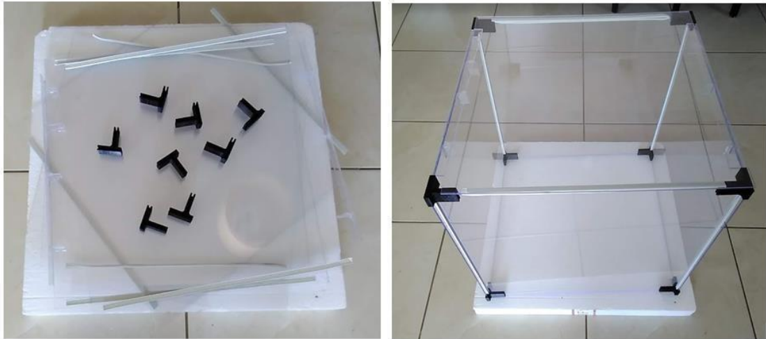
Σχήμα 16 : Τμήματα πλεξιγκλάς και οι 3D γωνίες για την σύνδεσής τους.
