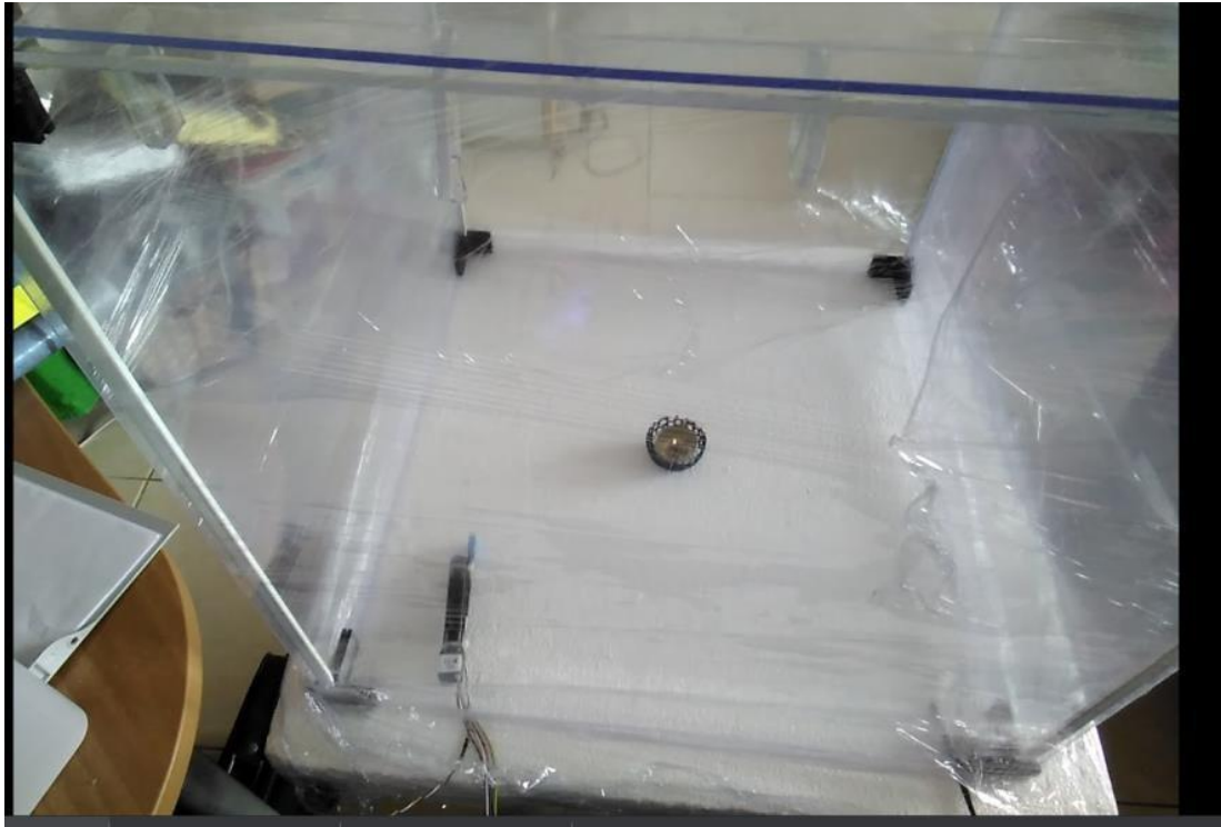
Σχήμα 18 : Ρεσό. Στα εσωτερικά τοιχώματα συμπυκνώνεται υγρασία από την έκλυση υδρατμών κατά την καύση των υδρογονανθράκων.
