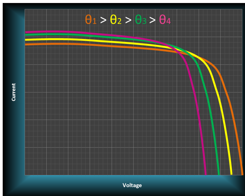
Σχήμα 1.9: Χαρακτηριστικές καμπύλες I-V για διάφορα επίπεδα θερμοκρασίας
