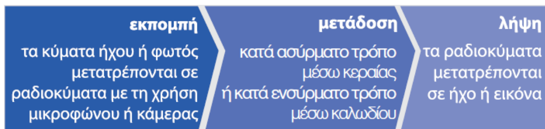
Σχήμα 5.2 Εκπομπή, μετάδοση και λήψη των ραδιοκυμάτων
