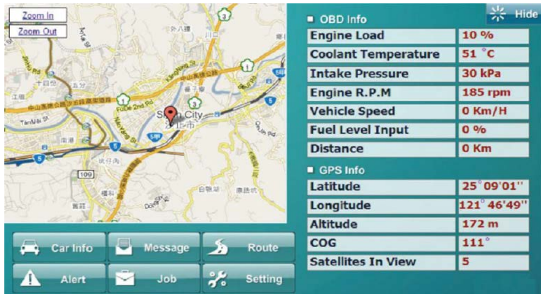
Εικόνα 4.2: Απεικόνιση εφαρμογής ενημέρωσης οχημάτων εν κινήσει με τη χρήση GPS.
