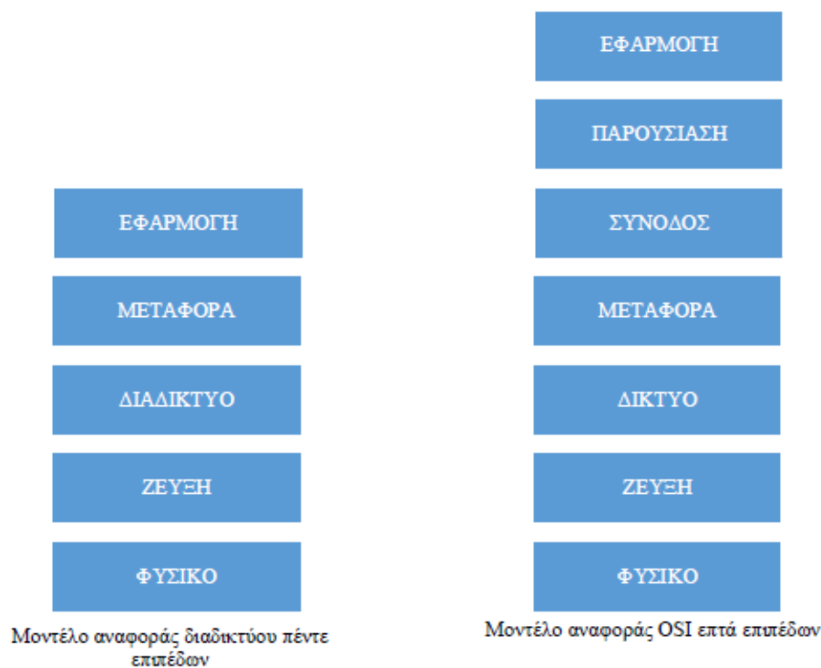
Εικόνα 1.12: Το μοντέλο αναφοράς διαδικτύου ή TCP/IP (αριστερά) και OSI (δεξιά).
