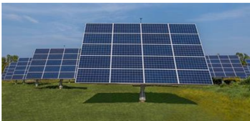
Εικόνα 2.13: Ιχνηλάτης διπλού άξονα all earth L20.
