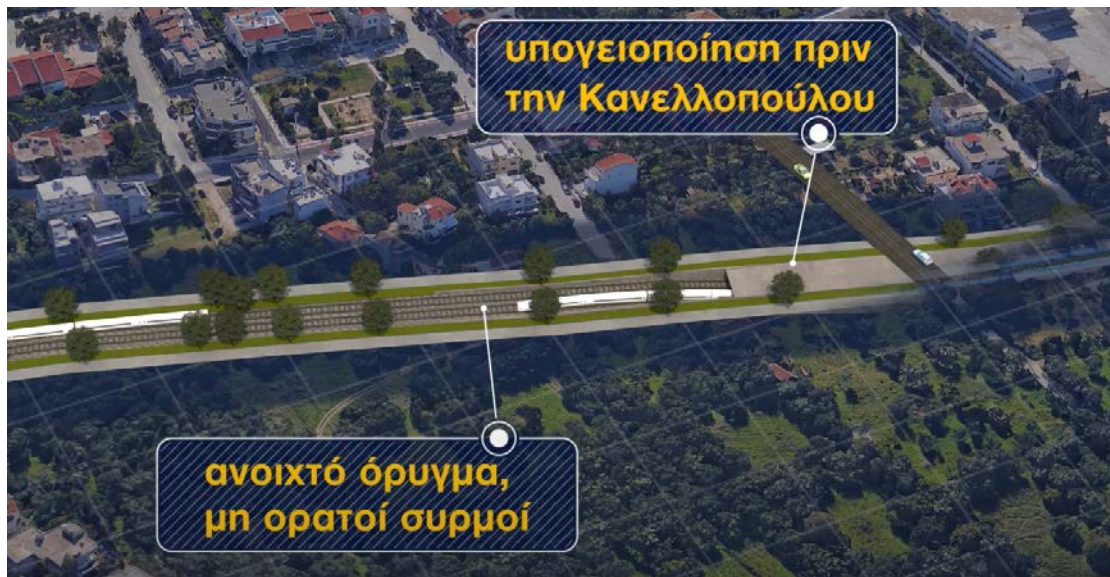
Εικόνα 57. Έναρξη υπόγειας διέλευσης. [31]
