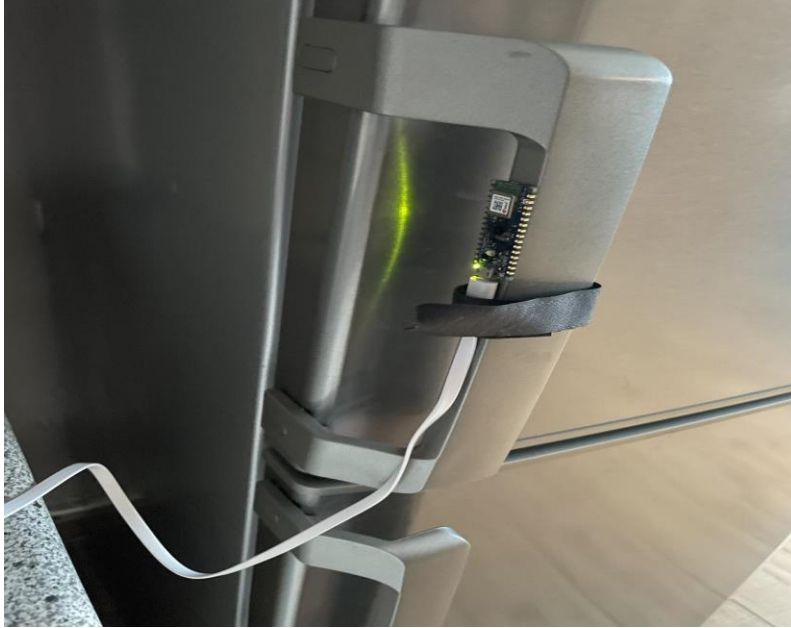
Εικόνα 3.1 : Arduino ενσωματωμένο στην πόρτα του ψυγείου
