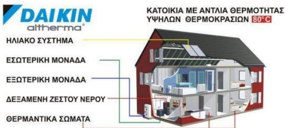
Εικόνα 2.4.3 Τυπικό σύστημα σύνδεσης αντλίας θερμότητας σε κεντρική θέρμανση κατοικίας της εταιρείας DAIKIN
