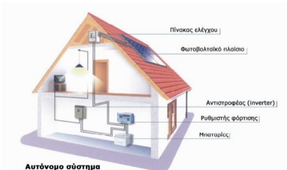
Εικόνα 2.2.11 Απεικόνιση αυτόνομου φωτοβολταϊκού συστήματος
