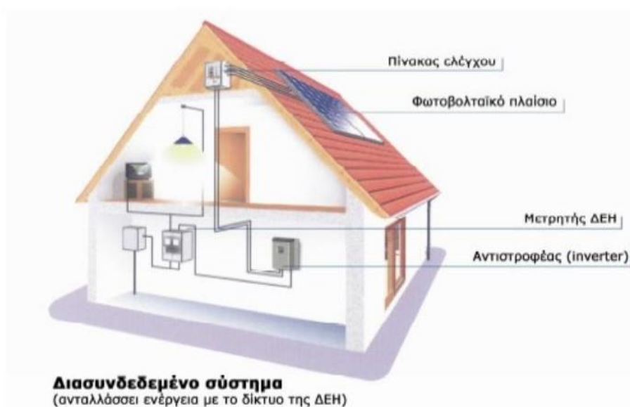
Εικόνα 2.2.9 Απεικόνιση διασυνδεδεμένου φωτοβολταϊκού συστήματος
