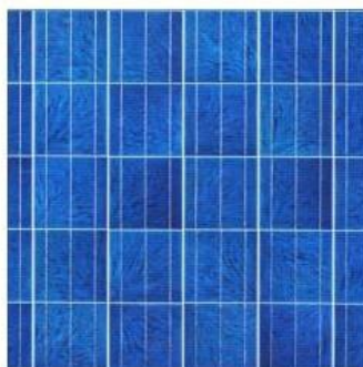
Εικόνα 2.2.5 Πολυκρυσταλλικό πυρίτιο σε φωτοβολταϊκό στοιχείο
