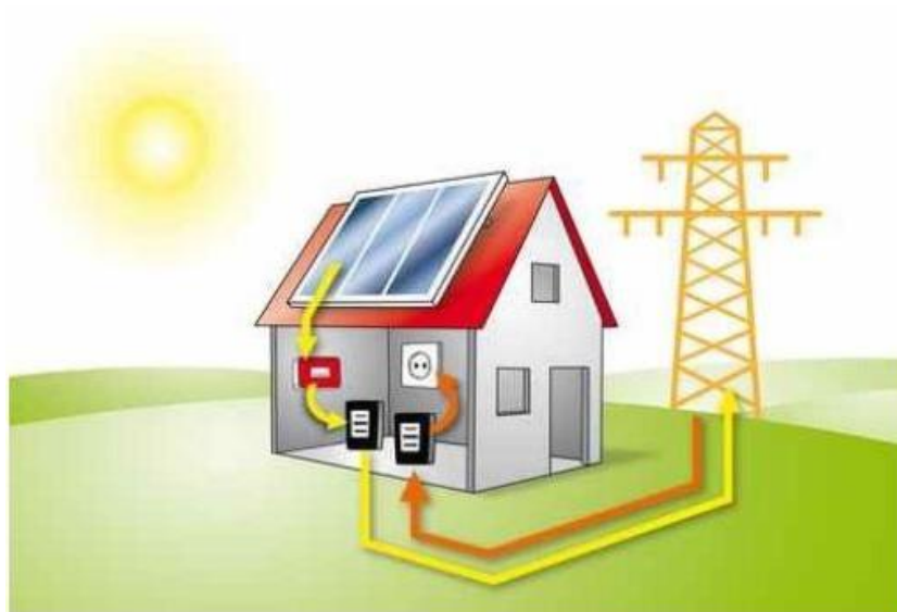
Εικόνα 2.3.2.3.2 Τυπική διάταξη φωτοβολταϊκού συστήματος αυτοπαραγωγής - net metering
