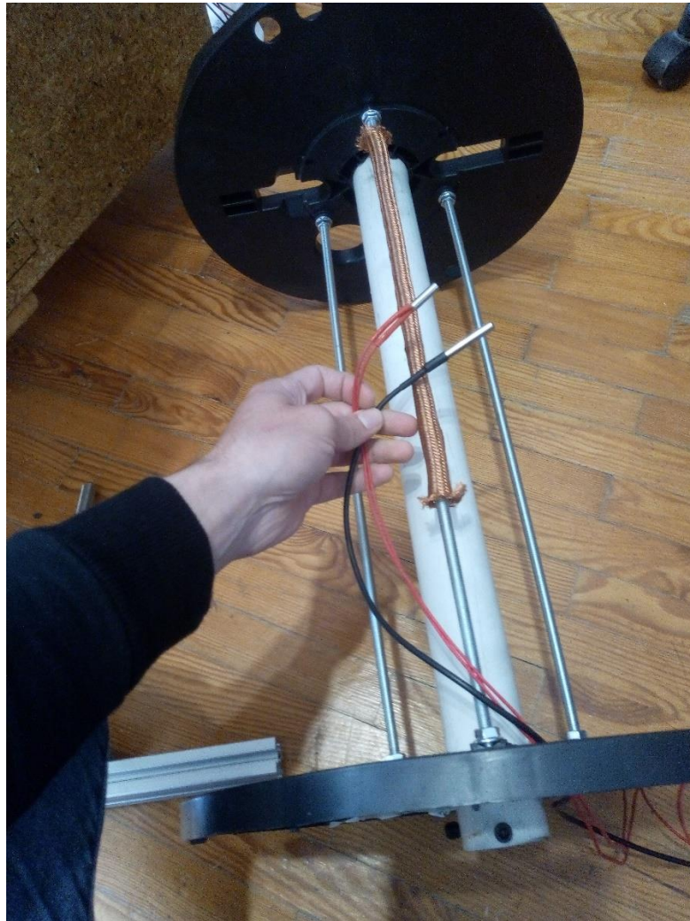
Εικόνα 7: Ο κάδος ανάδευσης κατά την τοποθέτηση αντιστάσεων και θερμομέτρων
