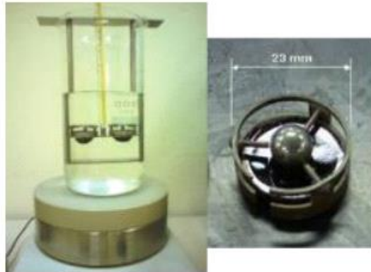
Εικόνα 15 Πειραματική διάταξη δοκιμής μάλθωσης
