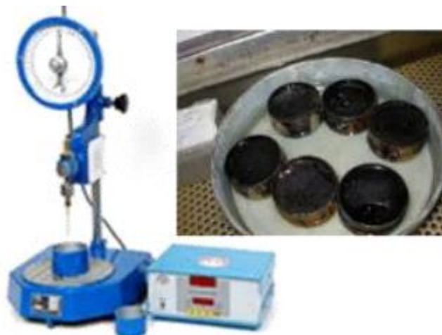
Εικόνα 13 Δοκίμια και συσκευή διεισδυτικότητας
