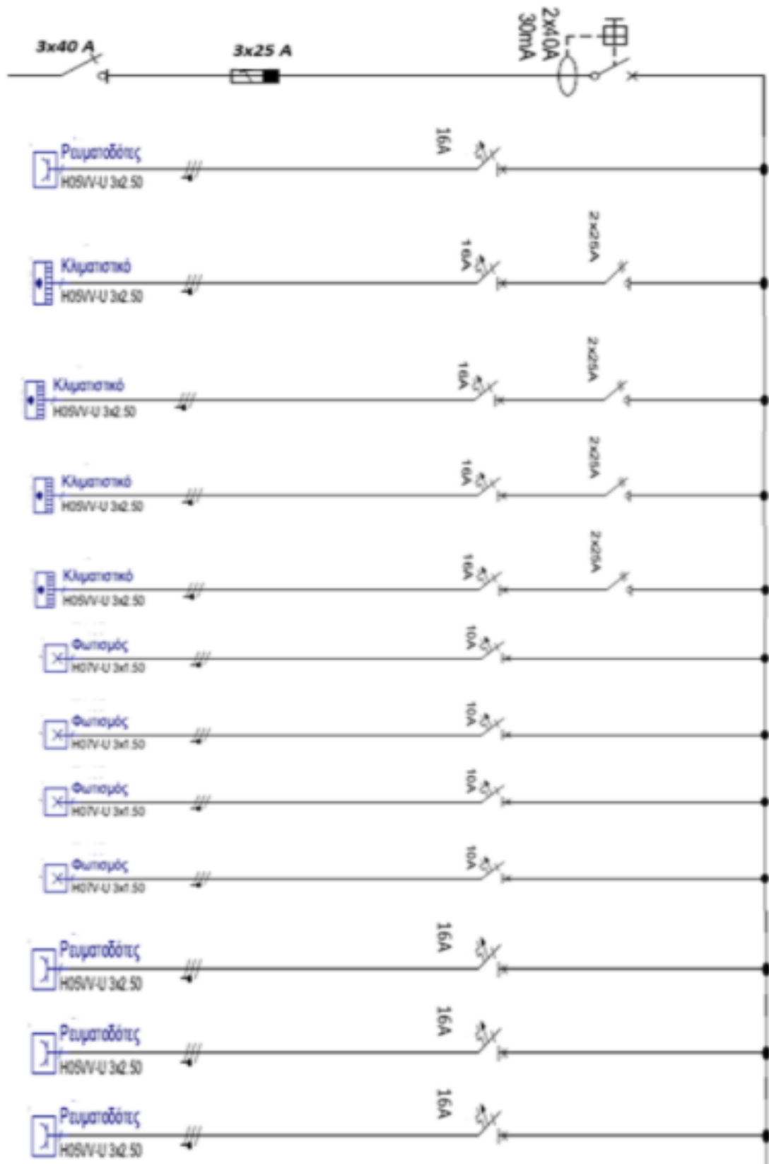
ΣΧΗΜΑ 5 Μονογραμμικό διάγραμμα του ΥΠ12 - Εργαστηρίων
