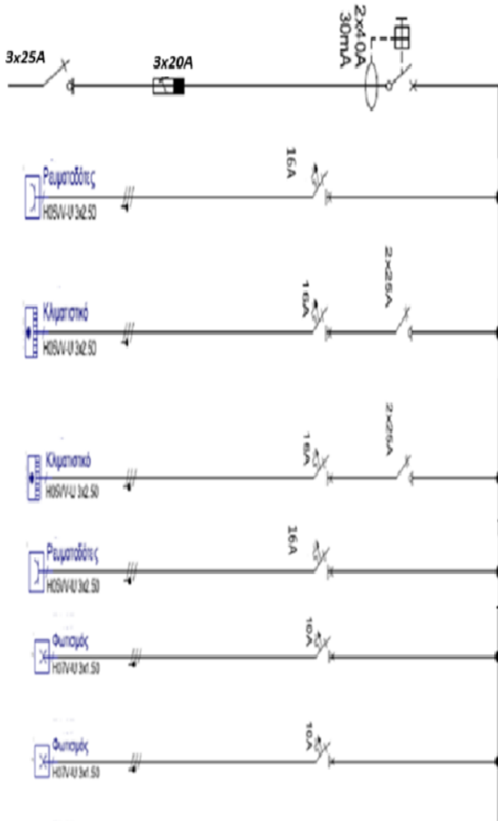
ΣΧΗΜΑ 4 Μονογραμμικό διάγραμμα του ΥΠ11-Γραφείο Διευθυντή-Υποδιευθυντή
