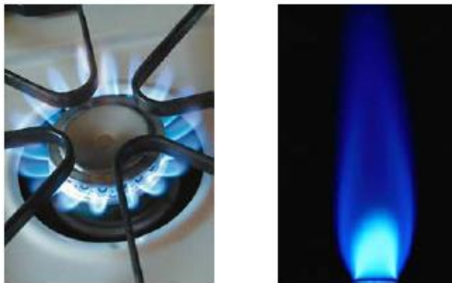
Εικόνα 1.3: Καύση του φυσικού αερίου με καθαρή μπλε φλόγα.
