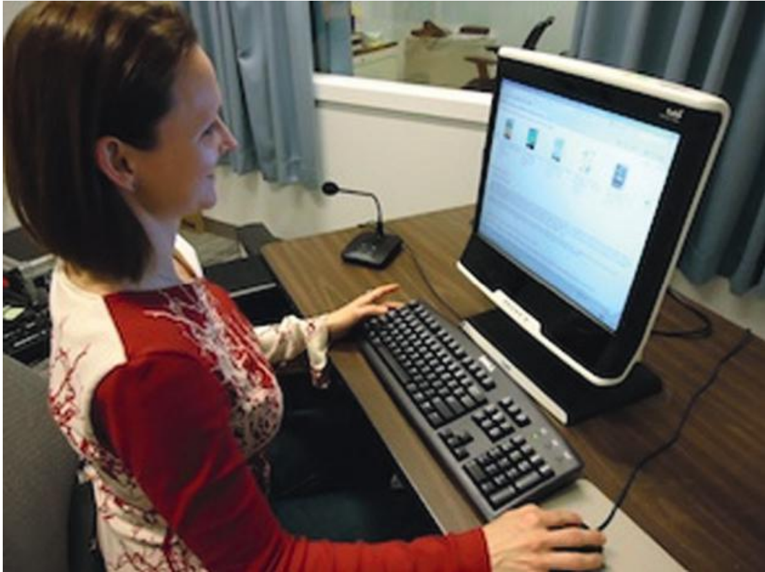
ΣΧΗΜΑ 36 Είναι εύκολο στην χρήση με την επιφάνεια εργασίας όπου η ιχνηλάτηση ματιών είναι ενσωματωμένη στην οθόνη.
