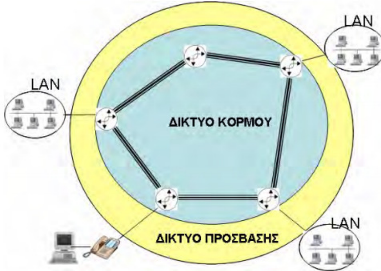
Σχήμα: 6-9 Σχηματική αναπαράσταση δικτύου πρόσβασης και δικτύου κορμού.
