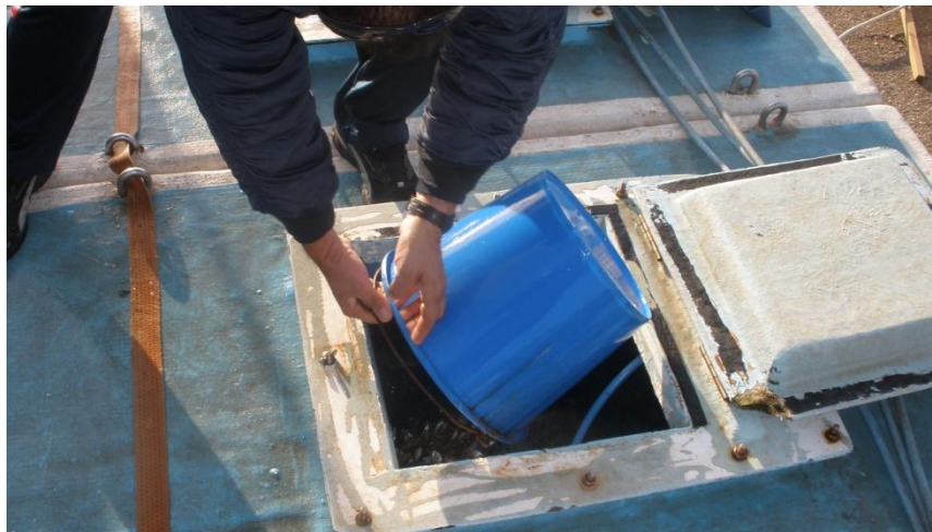
Εικ. 4.5. Καπάκι-άνοιγμα τοποθετημένο στην ανώτερη πλευρά των δεξαμενών μεταφοράς.
