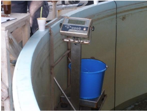
Εικ. 4.9. Ζυγαριά προσαρμοσμένη σε κατάλληλα διαμορφωμένη βάση ανάρτησης στα τοιχώματα της δεξαμενής γόνου.
