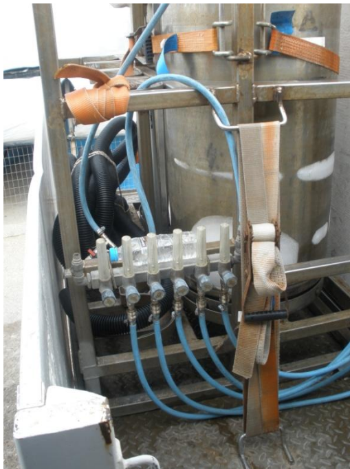
Εικ. 4.6. Δίκτυο μεταφοράς υγρού οξυγόνου στις δεξαμενές του φορτηγού.
