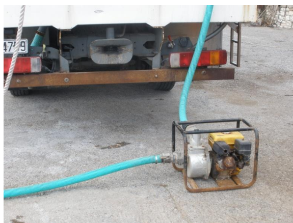
Εικ. 4.20. Αντλία νερού που μεταφέρει το νερό της θάλασσας στις δεξαμενές του φορτηγού.
