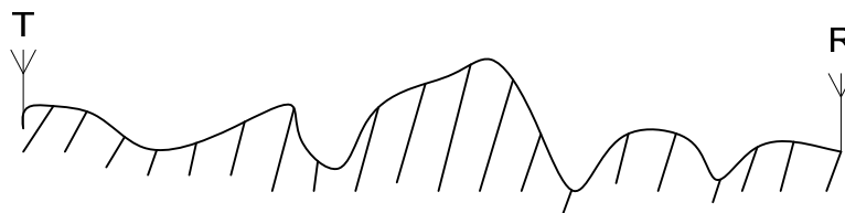
Εικόνα 2 Δείγμα ρεαλιστικής περίπτωσης ασύρματης ζεύξης
