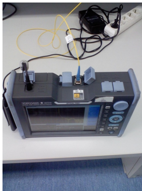
Εικόνα 9: Μηχάνημα OTDR (β)
