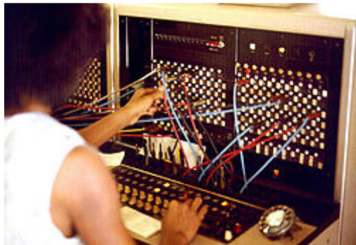
1.1 Ένας διαχειριστής τηλεφώνου συνδέει χειροκίνητα τις κλήσεις με ζευγάρια καλωδίων πάνω σε έναν πίνακα μεταγωγής τηλεφώνου.
