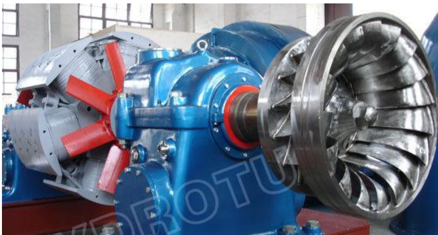
Εικόνα 20 Οριζόντιος υδροστρόβιλος του Francis (greek.hydrotu.com)
