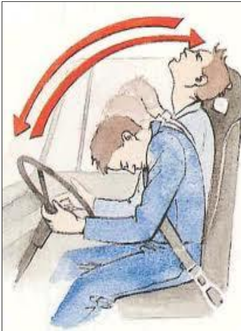
Εικόνα 6: Βασική λειτουργία του προσκέφαλου κατά την οδήγηση (Πηγή: http://drchad1.blogspot.gr )
