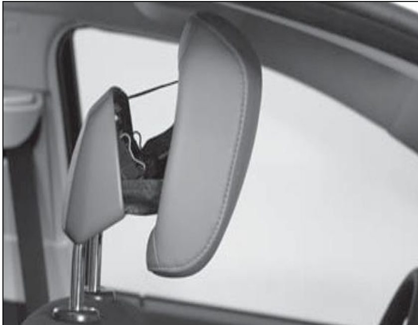
Εικόνα 9: Ενεργό προσκέφαλο με μηχανισμό (Πηγή: http://www.wk2jeeps.com/wk2_active_restraints.htm )
