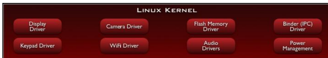
ΕΙΚΟΝΑ 39(ΑΠΕΙΚΟΝΙΣΗ ΤΟΥ ΕΠΙΠΕΔΟΥ ΠΥΡΗΝΑ ΤΟΥ LINUX, ΟΠΩΣ ΑΥΤΟΣ ΑΠΕΙΚΟΝΙΖΕΤΑΙ ΣΤΗΝ ΑΝΑΠΑΡΑΣΤΑΣΗ ΤΗΣ ΣΤΟΙΒΑΣ ΛΟΓΙΣΜΙΚΟΥ ΤΟΥ ΛΕΙΤΟΥΡΓΙΚΟΥ ΣΥΣΤΗΜΑΤΟΣ ANDROID-πηγή: pcomonster.gr)
