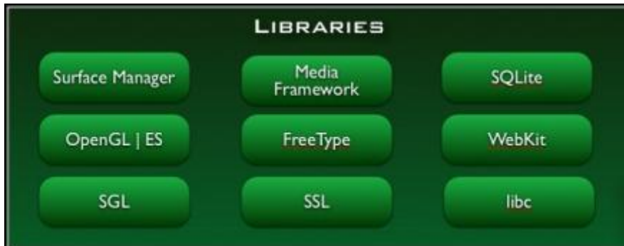
ΕΙΚΟΝΑ 38 (ΑΠΕΙΚΟΝΙΣΗ ΤΟΥ ΕΠΙΠΕΔΟΥ ΒΙΒΛΙΟΘΗΚΩΝ, ΟΠΩΣ ΑΥΤΗ ΑΠΕΙΚΟΝΙΖΕΤΑΙ ΣΤΗΝ ΑΝΑΠΑΡΑΣΤΑΣΗ ΤΗΣ ΣΤΟΙΒΑΣ ΛΟΓΙΣΜΙΚΟΥ ΤΟΥ ΛΕΙΤΟΥΡΓΙΚΟΥ ΣΥΣΤΗΜΑΤΟΣ ANDROID – πηγή: pcmonster.gr)
