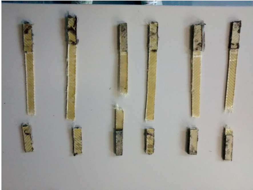
Σχήμα 7.11: Δοκίμια αραμιδίου μετά το πείραμα εφελκυσμού, από αριστερά είναι το πρώτο και συνεχίζει η αρίθμηση τους ως το έκτο.
