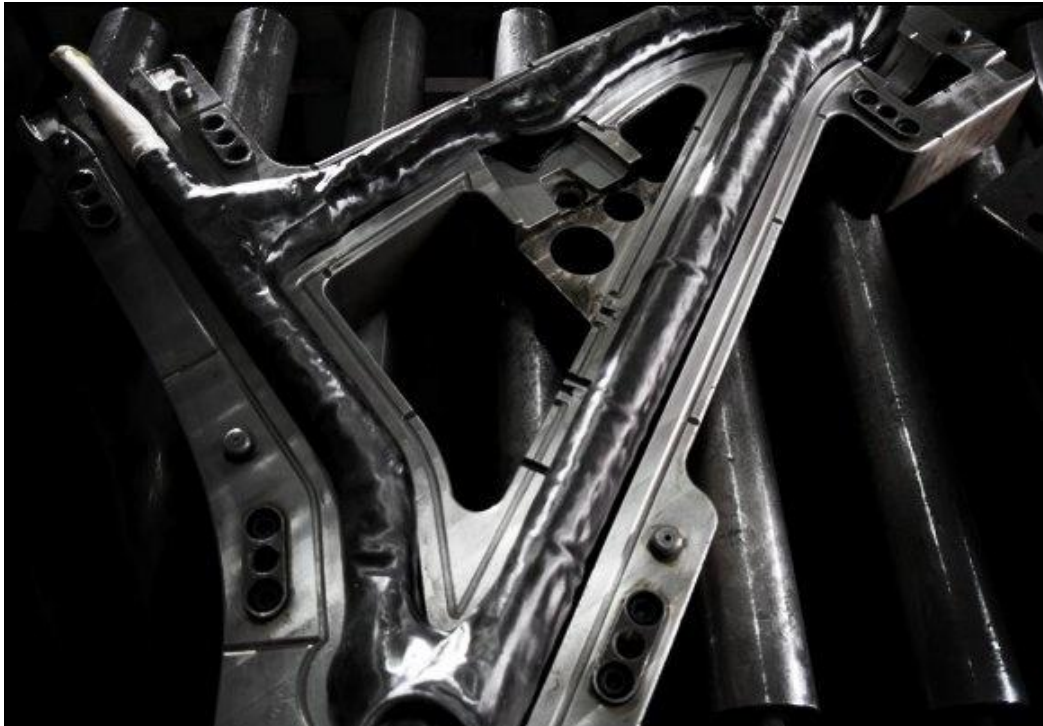
Εικόνα 1.1: Διαιρετό καλούπι, από σκελετό ποδηλάτου. Το ύφασμα ανθρακονήματος τοποθετείται με το χέρι στο αρσενικό και το θηλυκό καλούπι, κλείνει και ακολουθεί η διαδικασία παραγωγής του.
