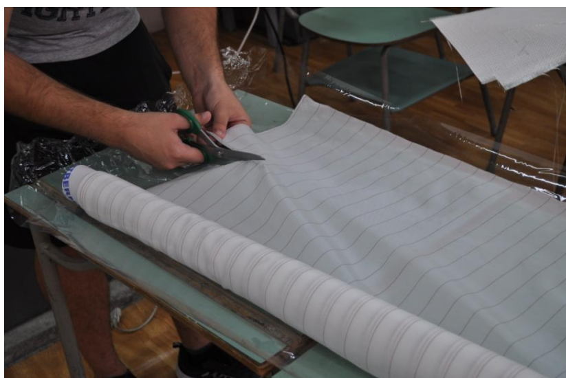
Εικόνα 6.18: Κοπή υφάσματος αποκόλλησης.
