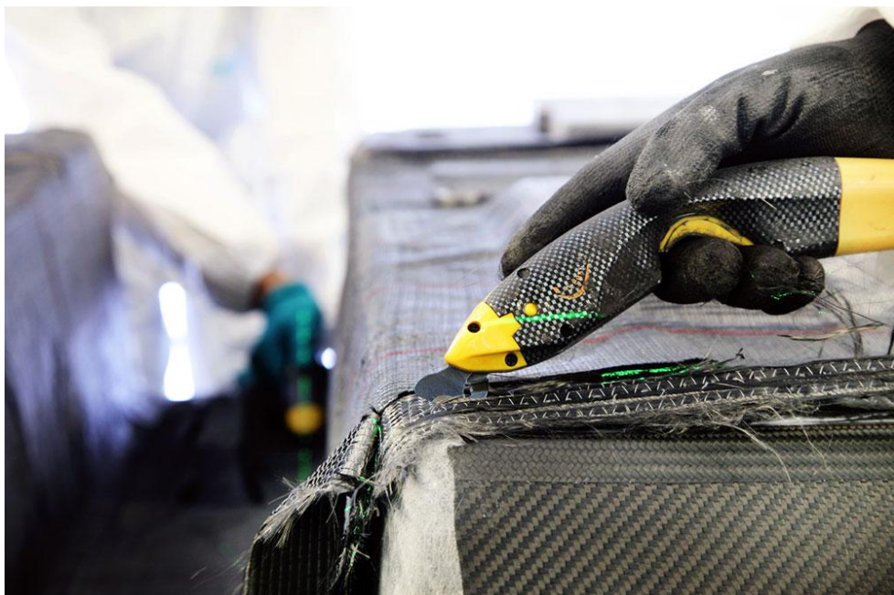
Εικόνα 5.7: Κοπή ανθρακοϋφάσματος με ηλεκτρικό ψαλίδι.
