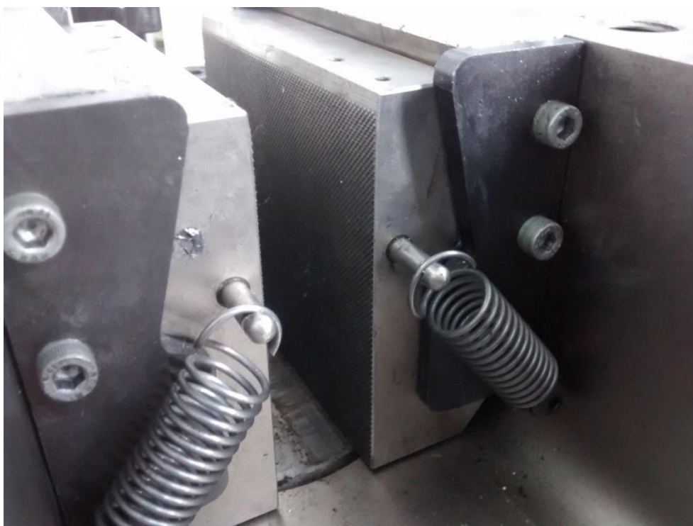
Εικόνα 5.4: Αρπάγες μηχανής εφελκυσμού 1-12 (mm) μηχανής INSTRON 8802.
