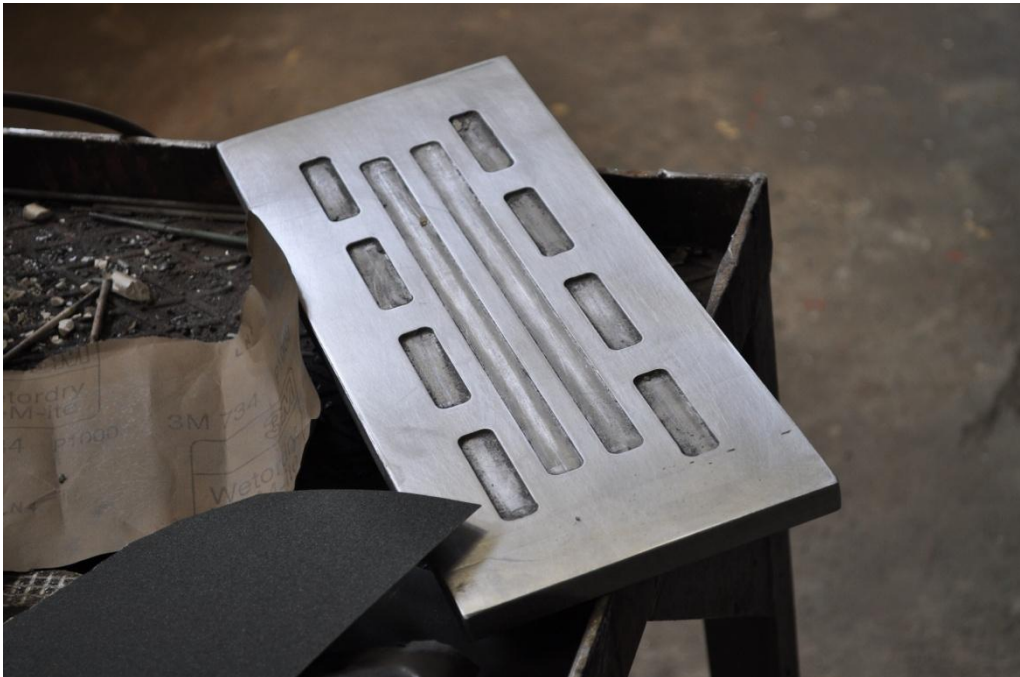
Εικόνα 6.14: Καλούπι παρασκευής δοκιμίων σύνθετων υλικών.
