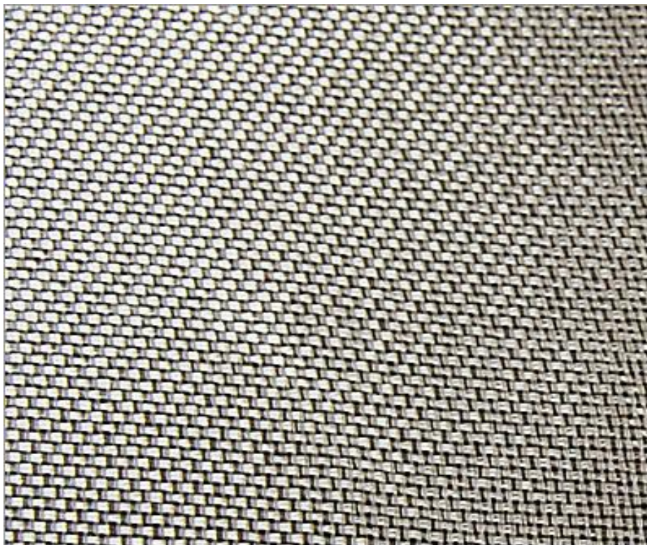
Εικόνα 2.2: Υαλοϋφασμα τύπου S-glass στρατιωτικής χρήσης, κατασκευαστής (HEXCEL) .
