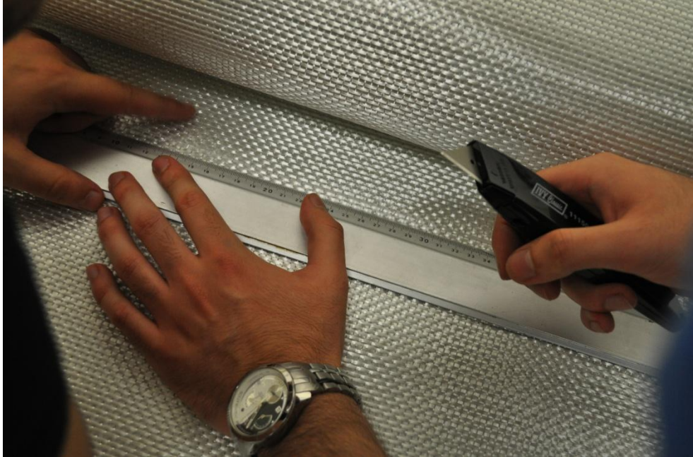
Εικόνα 6.4: Ύφασμα υαλονήματος 3D non crimp πλέξης σε διαδικασία κοπής στο εργαστήριο Τεχνολογίας Υλικών.
