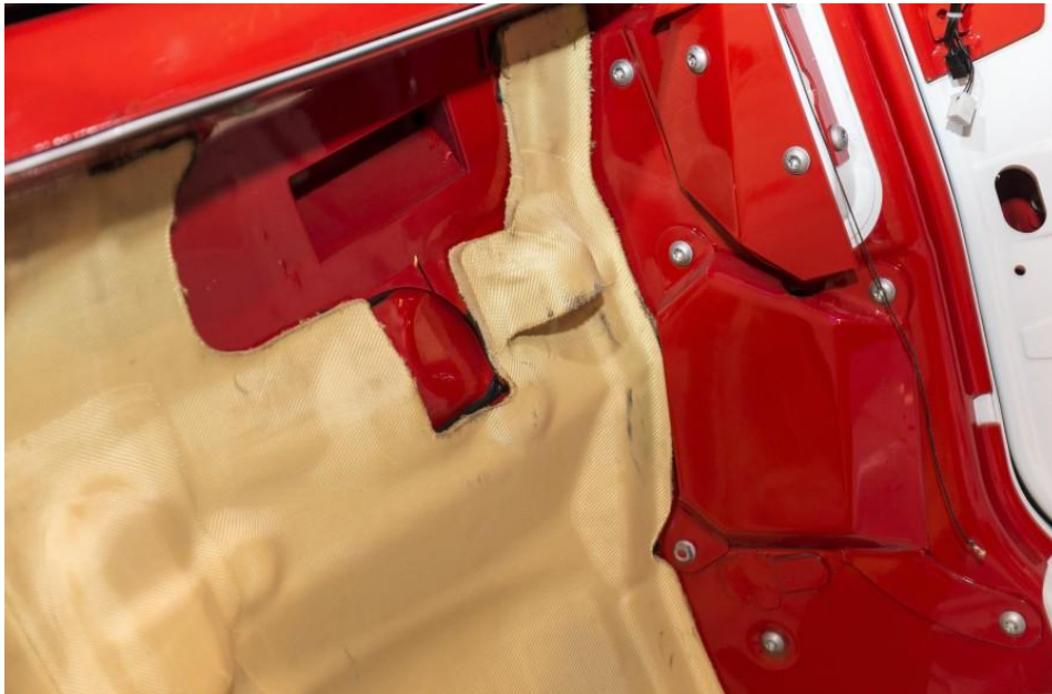
Εικόνα 3.1: Τοποθέτηση Kevlar σε πόρτα οχήματος για θωράκιση.
