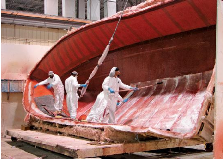
Εικόνα 2.4: Κατασκευή σκάφους από υαλόνημα.
