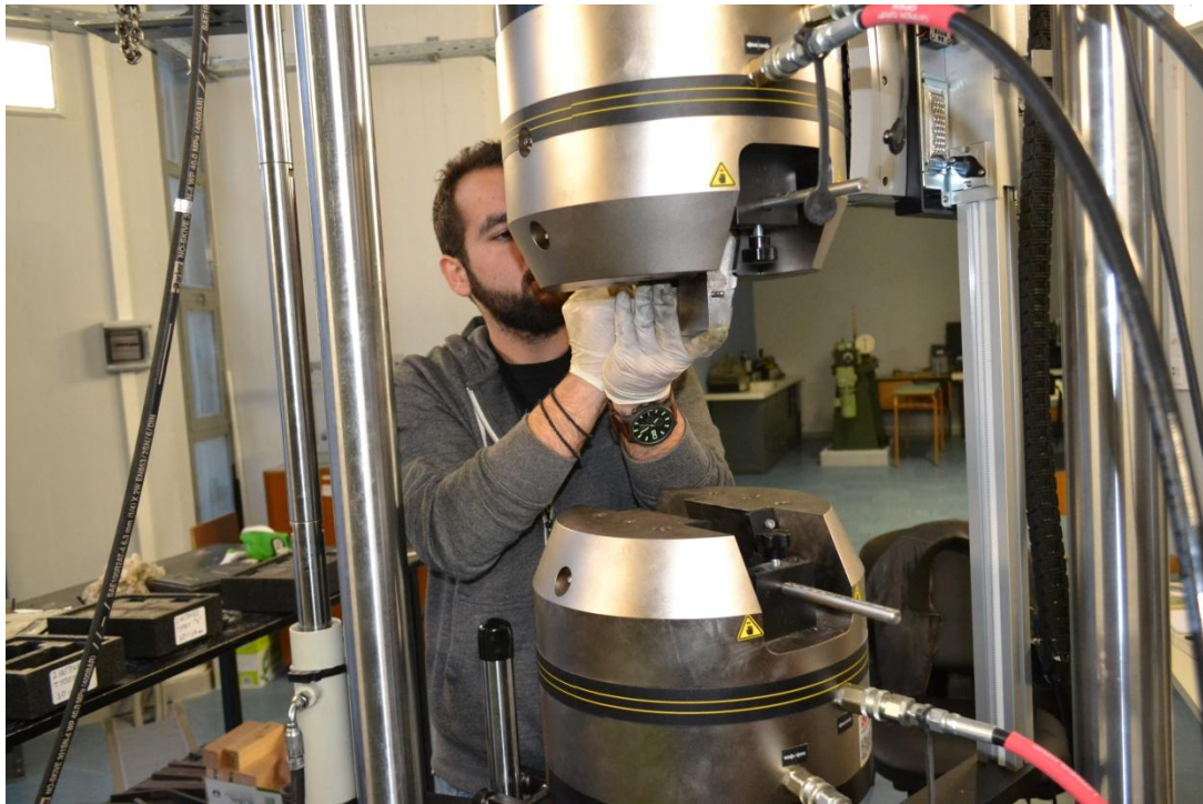
Εικόνα 7.5: Τοποθέτηση αρπάγης στη μηχανή.
