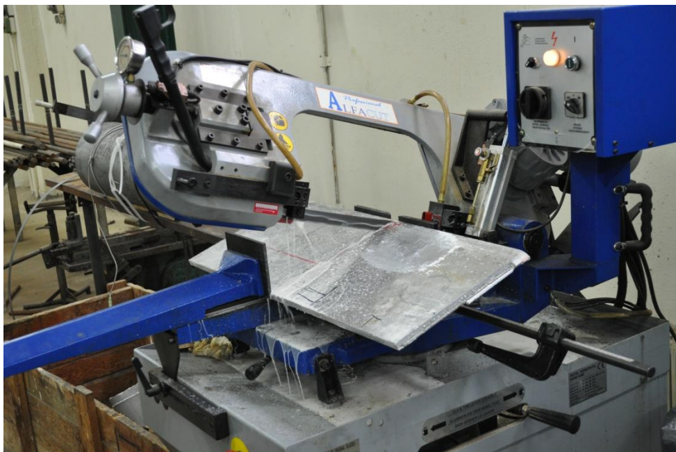
Εικόνα 6.10: Κοπή μεταλλικής πλάκας αλουμινίου για το καλούπι.
