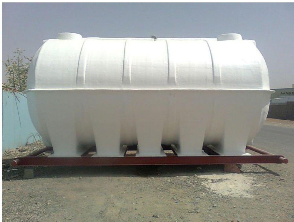
Εικόνα 2.6: Δεξαμενή GRP για αποθήκευση υγρών.
