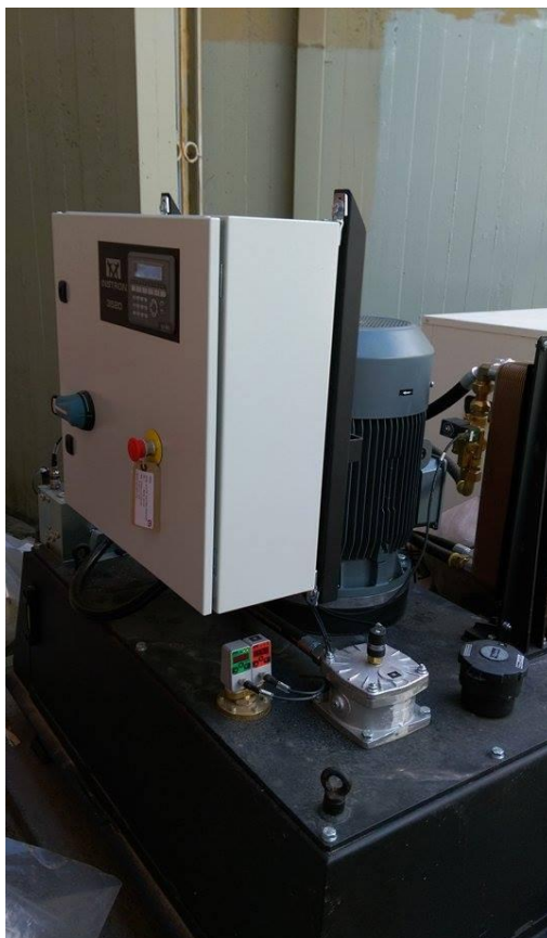
Εικόνα 7.2: Ηλεκτροκινητήρας μηχανής εφελκυσμού.
