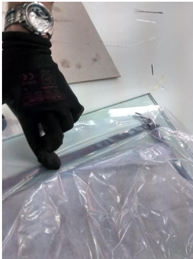
Εικόνα 6.25: Τοποθέτηση φιλμ κενού.
