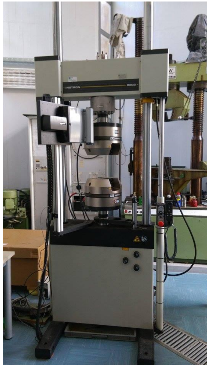
Εικόνα 7.1: Μηχανή εφελκυσμού INSTON 8802.
