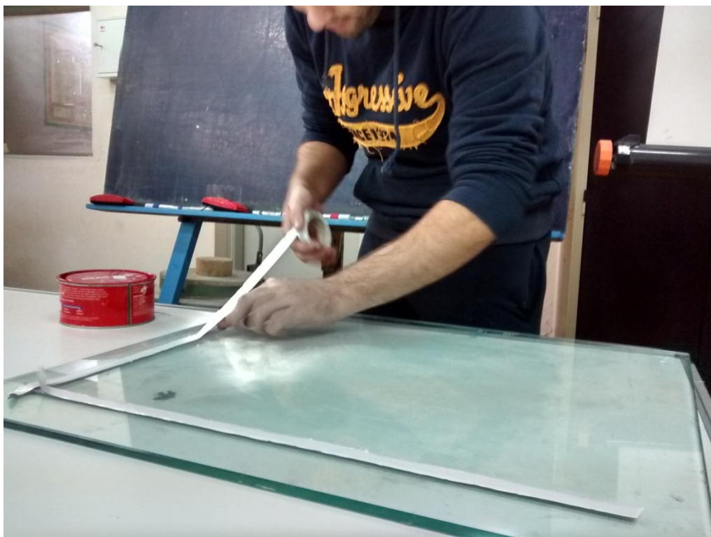
Εικόνα 6.15: Καλούπι και τοποθέτηση μαστιχοταινίας.
