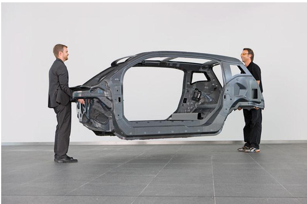
Εικόνα 1.10: Πλαίσιο μονοκομπε από CFRP (βάρος 150 Kgr).
