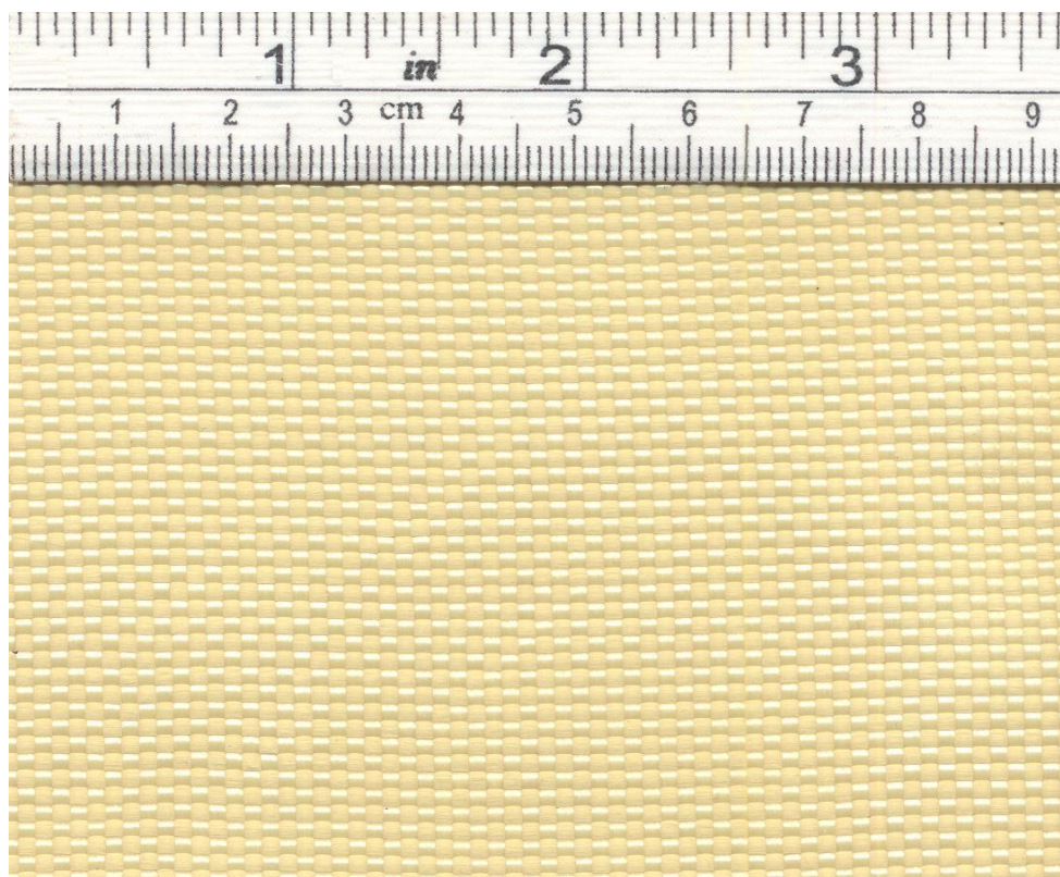
Εικόνα 3.3: Ύφασμα βαλλιστικού αραμιδίου μονής πλέξης, κωδικός K468P, βάρος 460 \text{ gr/m}^2 . Στημόνι 50% 3300 tdex αραμίδιο του υφάσματος, 6,7 κλωστές ανά εκατοστό. Υφάδι 50% 3300 tdex του υφάσματος, 6,7 κλωστές ανά εκατοστό.
