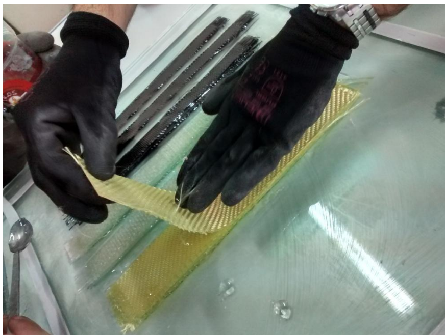
Εικόνα 6.22: Τοποθέτηση στρώσεων υφασμάτων αραμιδίου.
