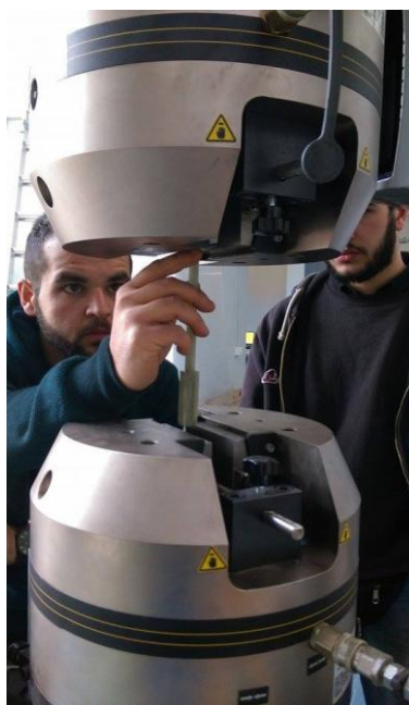
Εικόνα 5.9: Τοποθέτηση και ευθυγράμμιση δοκιμίου.
