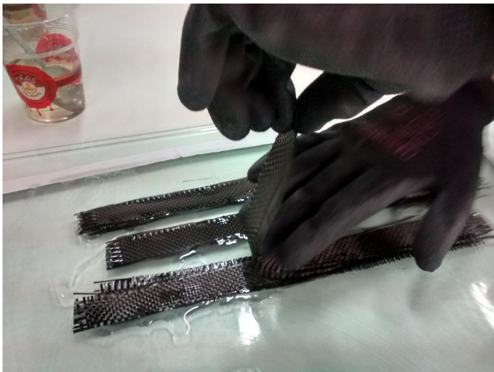
Εικόνα 6.21: Τοποθέτηση στρώσεων υφασμάτων ανθρακονήματος.
