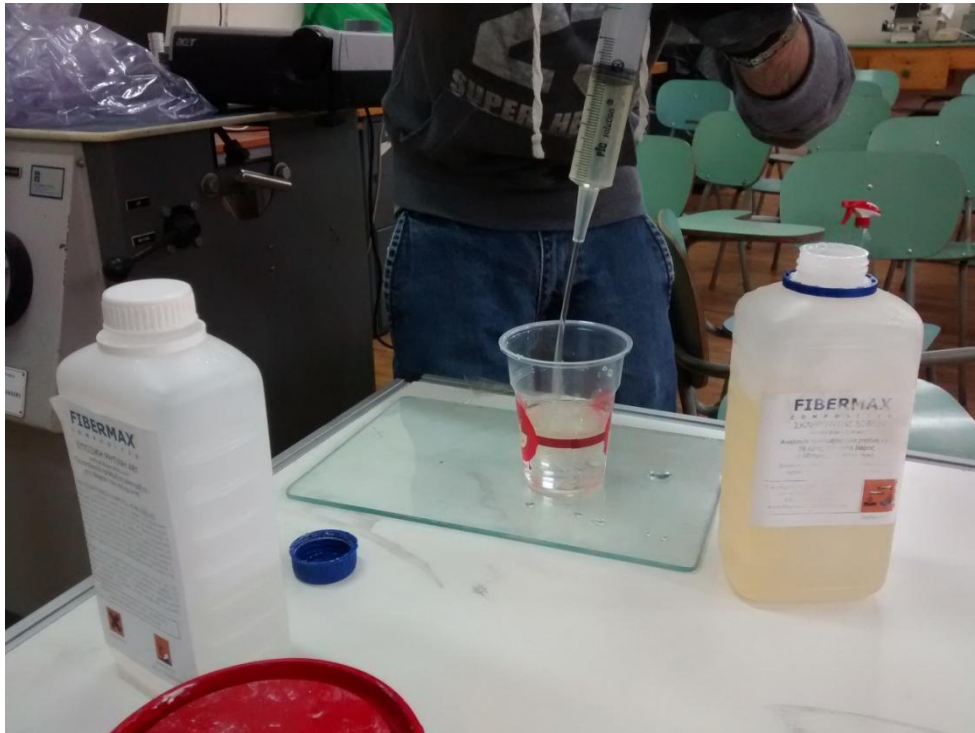
Εικόνα 6.20: Εποξικό σύστημα ρητίνης-σκληρυντή.
