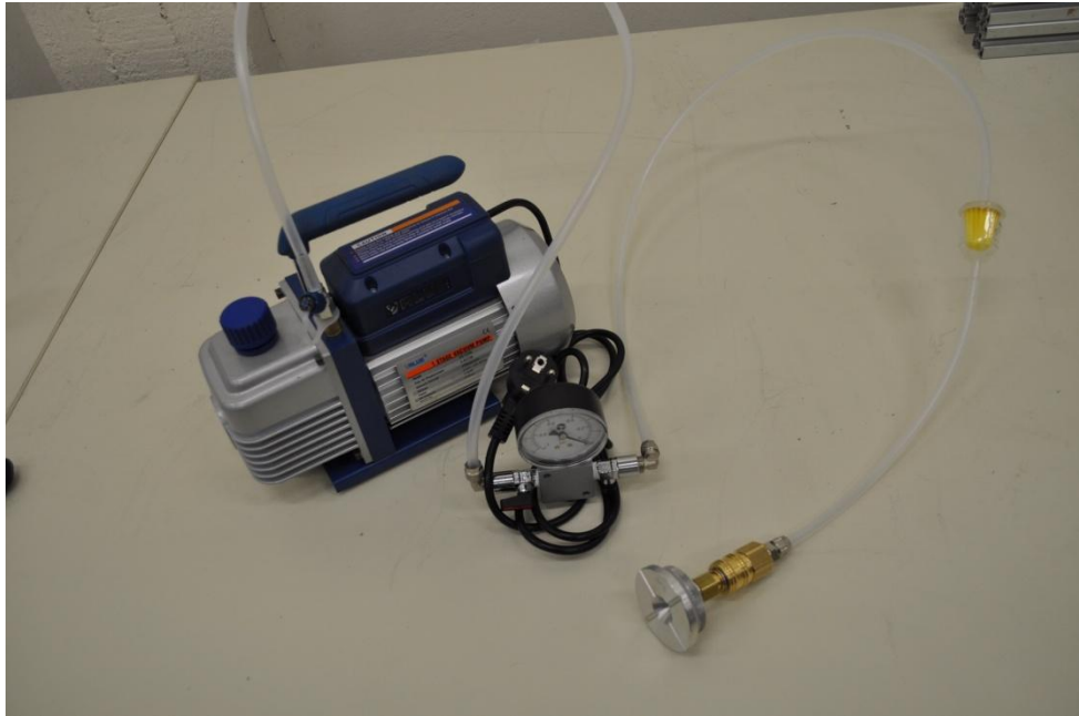
Εικόνα 6.9: Αντλία κενού, σωλήνας PVC, μανόμετρο, παγίδα και αντάπτορας για τη σακούλα κενού.
