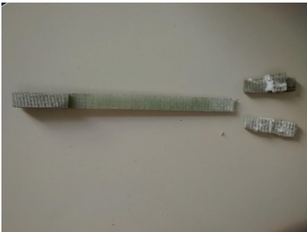
Εικόνα 7.14: Δοκίμιο υαλονήματος, αστοχία στα επιθέματα μέσα στην αρπάγη.
