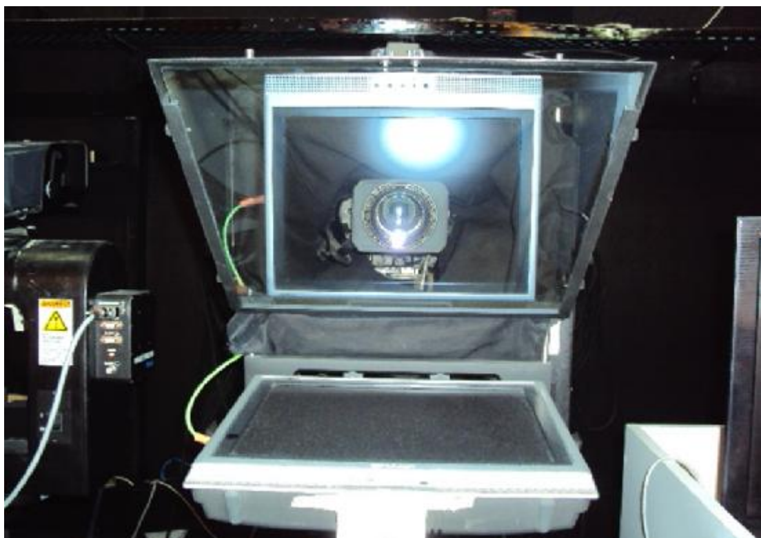
Εικόνα 4.8: Το autocue που βοηθά τους δημοσιογράφους στο να διαβάσουν το καθορισμένο κείμενο και να κοιτάνε μέσα στην κάμερα
