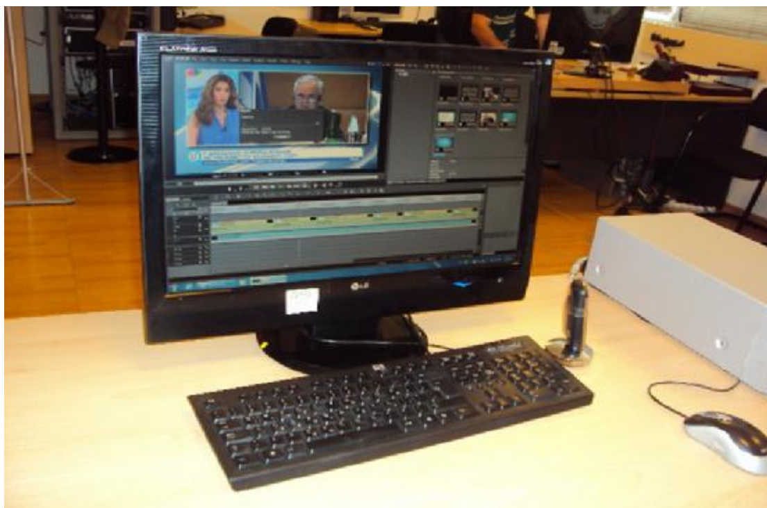
Εικόνα 4.10: Με αυτόν τον υπολογιστή τοποθετούνται οι λεζάντες των εκπομπών (γεννήτρια χαρακτήρων)
