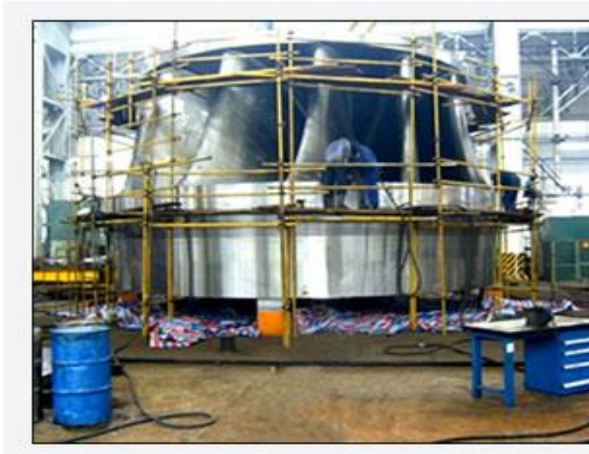
Εικόνα 5.2: Μονοκόμματα κατασκευή δρομέα Francis από ανοξείδωτο ατσάλι
