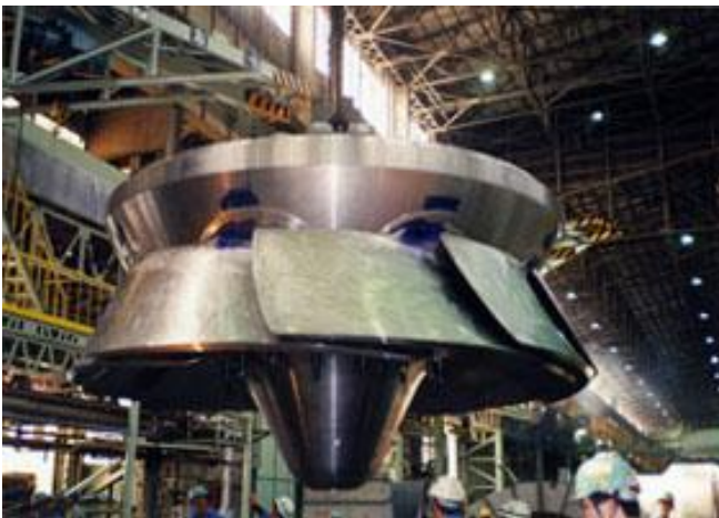
Εικόνα 16 : Στρόβιλος Deriaz υπό συντήρηση
