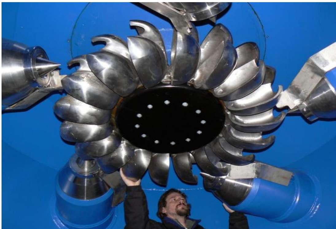
Εικόνα 1: Συντήρηση υδροστροβίλου Pelton.
