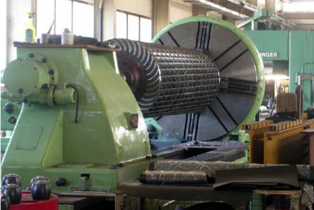
Εικόνα 9 : υδροστρόβιλος Cross Flow υπό κατασκευή
