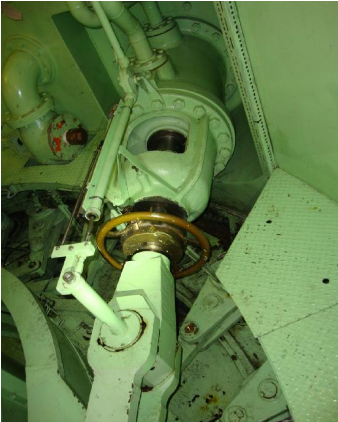
Εικόνα 5.5: Ο ένας από τους δύο αντιπαράλληλους σέρβο – κινητήρες.
