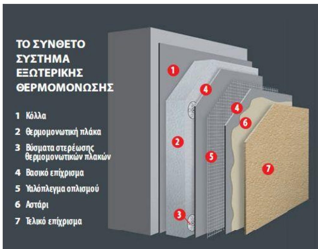
Εικόνα 21: Το σύστημα εξωτερικής θερμομόνωσης
