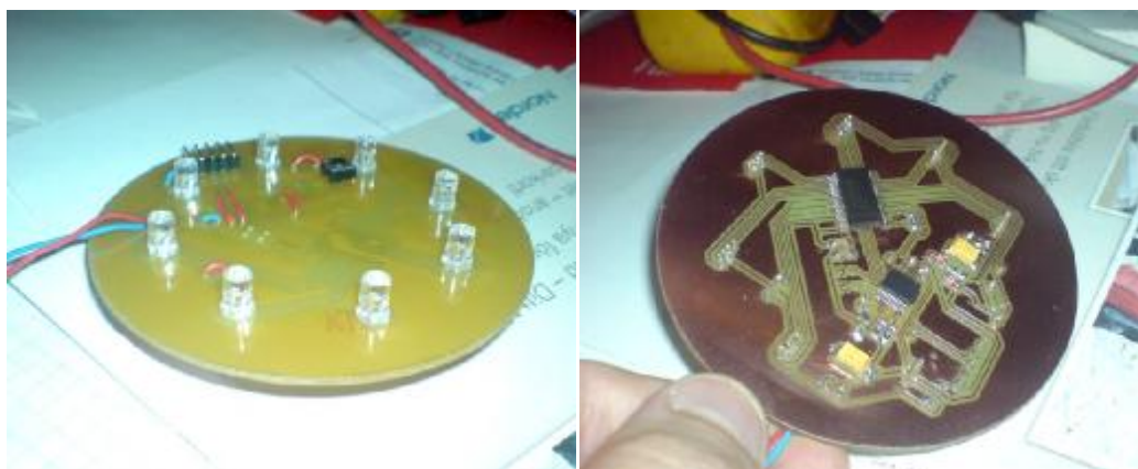
Εικόνα 9: Λαμπτήρες Led σε πινάκες αποτύπωσης
