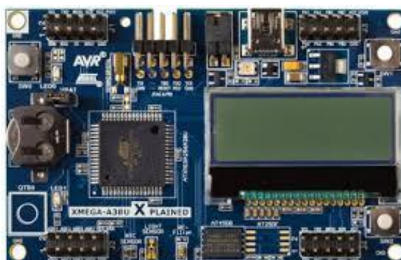
Εικόνα 11. Evaluation Board για τον μικροελεγκτή ATxMEGA256A3BU
