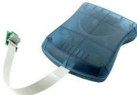
Εικόνα 12. Εργαλείο προγραμματισμού για τον μικροελεγκτή ATxMEGA256A3BU
