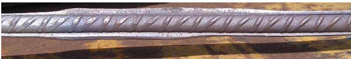
Εικόνα 48: Ράβδος με Υψηλή Διαμήκης Νεύρωση (Πηγή: Προσωπικό Αρχείο)
