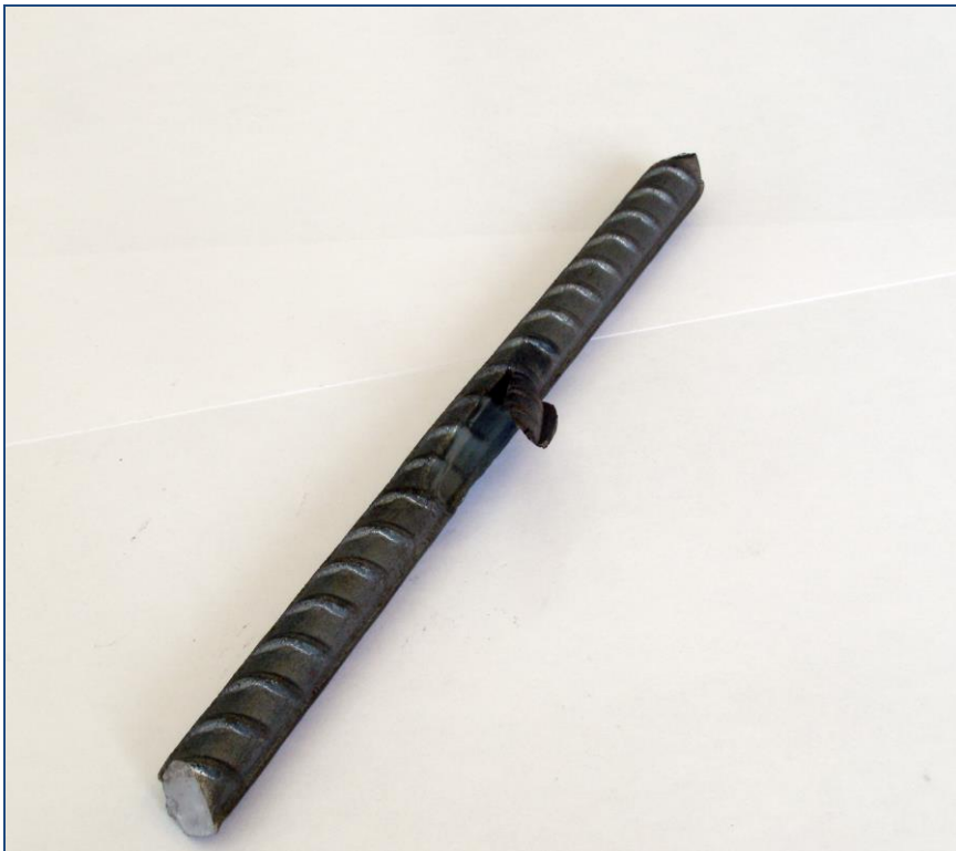
Εικόνα 50: Ράβδος με Επιφανειακή Αποφλοιώση (Πηγή: Προσωπικό Αρχείο)
