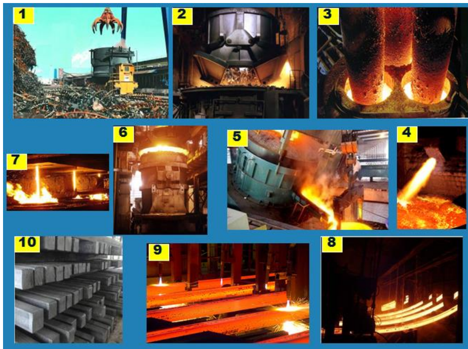
Εικόνα 3: Μέθοδος βασικής καμίνου οξυγόνου (Πηγή: Προσωπικό αρχείο)
