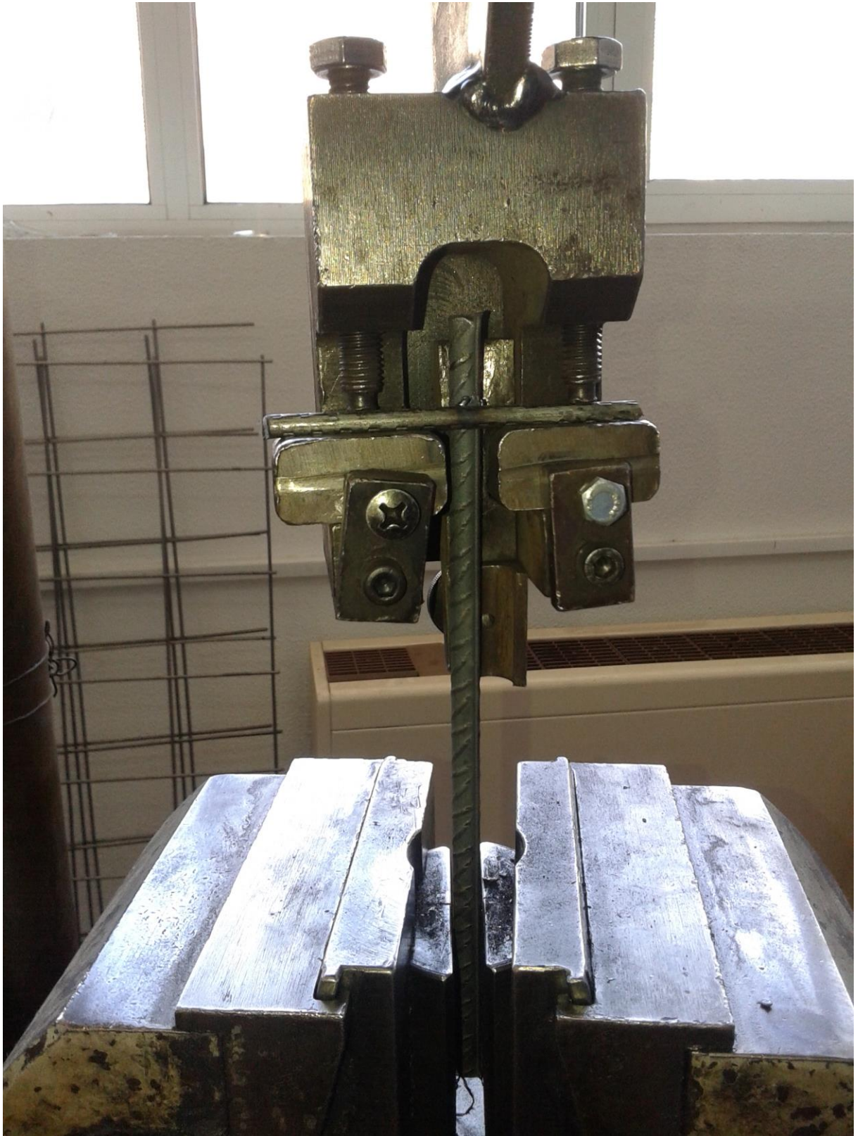
Εικόνα 33: Δοκίμιο τοποθετημένο στην Μηχανή Διάτμησης έτοιμο προς Έλεγχο (Πηγή: Προσωπικό αρχείο)
