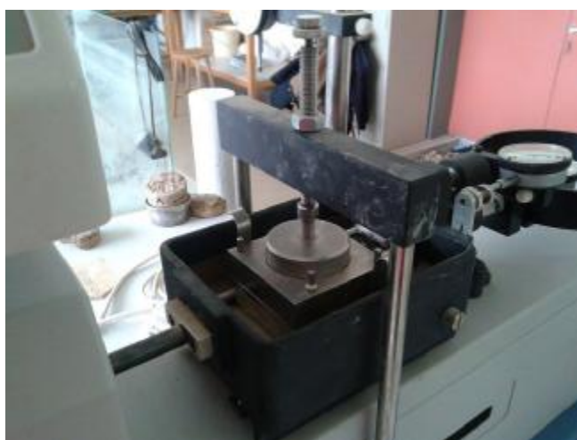
Τοποθέτηση κατακόρυφης τάσης
