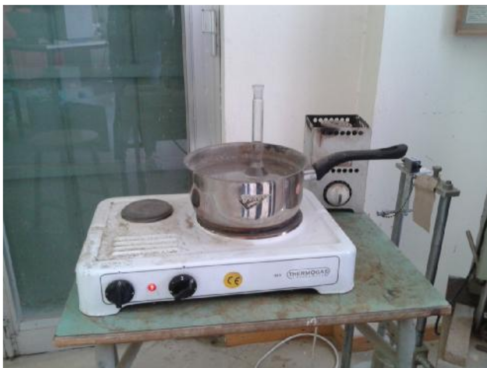
Λουτρό θερμού νερού
