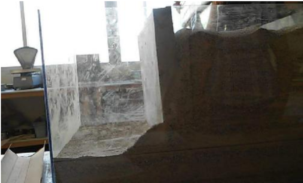
Παρατηρούμε ότι έχει περάσει άμμος στην αριστερή πλευρά του τοίχου
