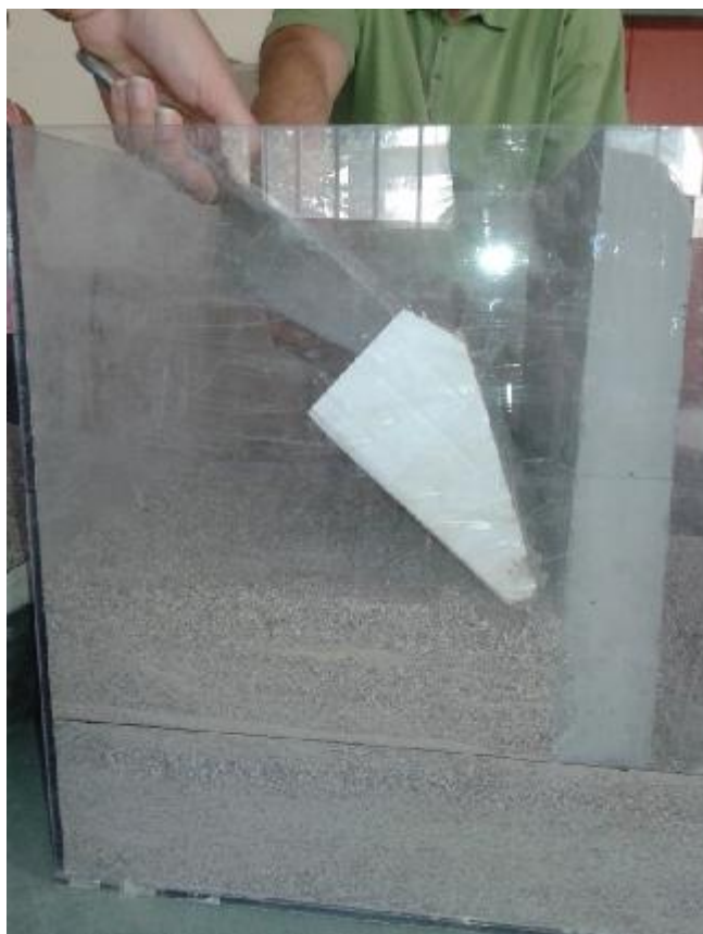
Τοποθέτηση άμμου με συσκευή διάστρωσης
