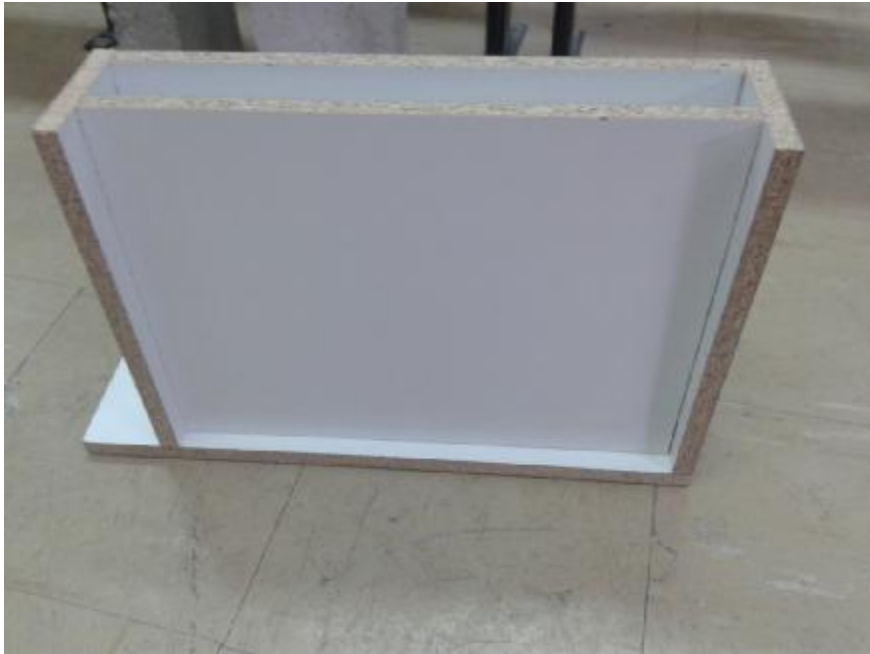
Καλούπι (διακρίνεται η κλίση στην μια πλευρά του τοίχου)
