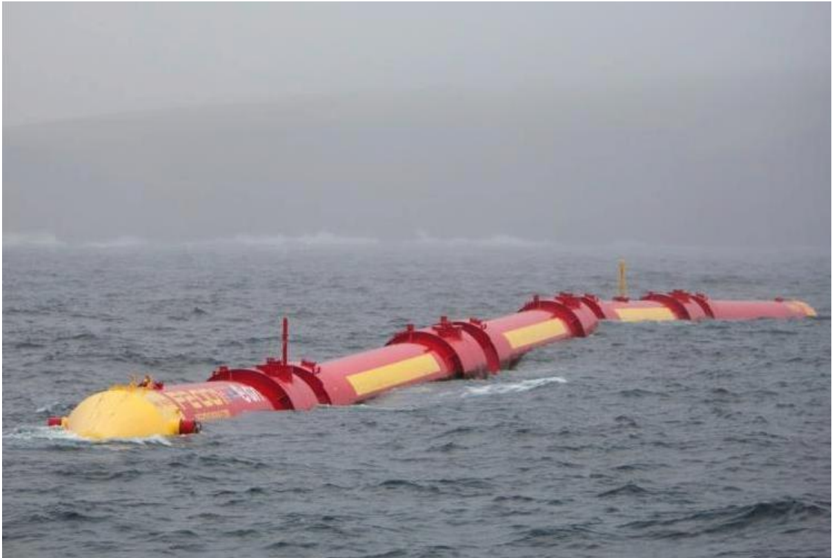
Εικόνα 10. Εφαρμογή υδραυλικού κυματοθραύστη στα ανοιχτά της Πορτογαλίας. ( www.saveplanet.gr )
