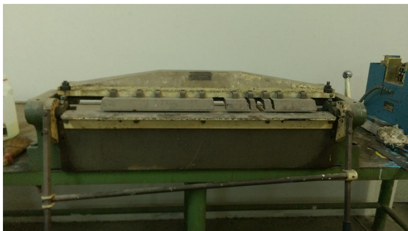
Εικόνα 5.42 : Στράντζα χειροκίνητης λειτουργίας για κάμψη ελάσματος έως 1.5 mm
