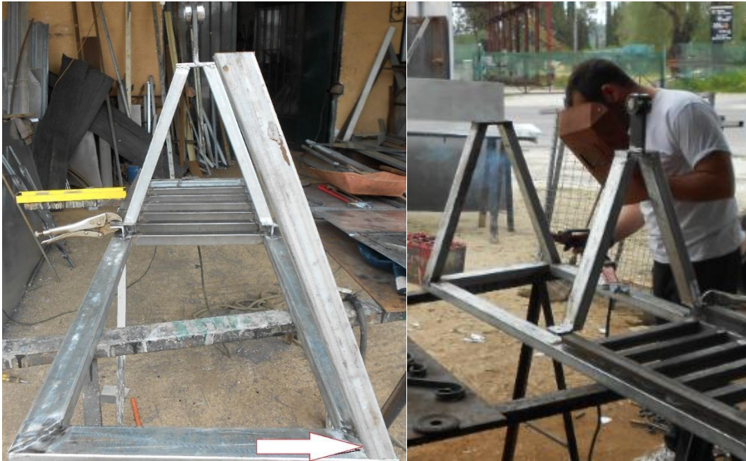
Εικόνα 5.29: Συγκόλληση βραχιόνων επάνω στην κεντρική βάση
