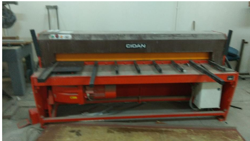
Εικόνα 5.41 : Μηχανικό ψαλίδι κοπής ελασμάτων πάχους έως 2.5mm
