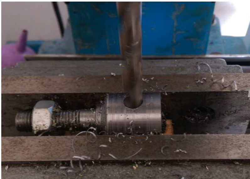
Εικ. 5.32: Διάνοιξη οπής για ντίζα
