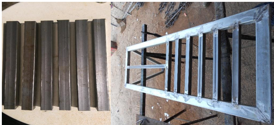
Εικ. 5.18: Εσωτερική ενίσχυση πλαισίου
