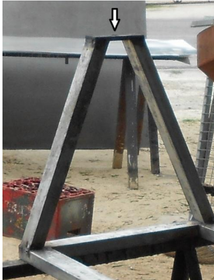
Εικ. 5.30: Θέση οπής από την οποία διέρχεται ο άξονας του συνδέσμου άρθρωσης
