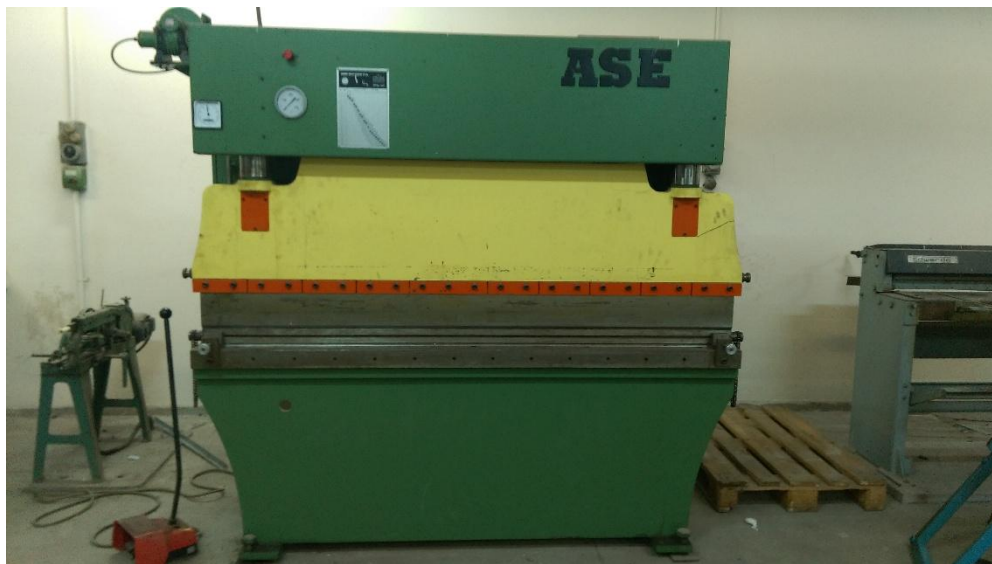
Εικόνα 5.39 : Πρέσα υδραυλικής πίεσης δυναμικότητας 60 τόνων
