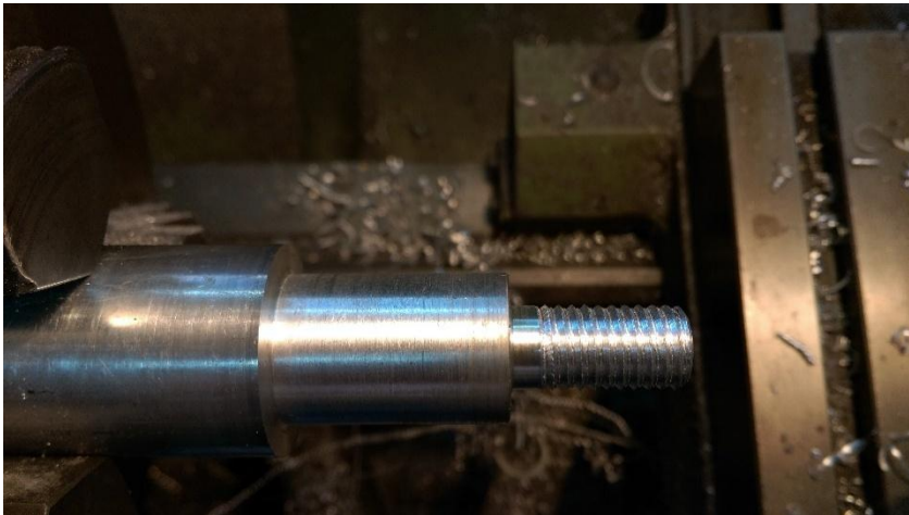
Εικόνα 5.27: Κατασκευή σπειρώματος M12 x 1.5
