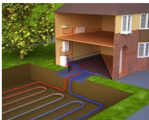
Σχήμα 3.14 Απεικόνιση γεωθερμικής αντλίας θερμότητας με σωληνώσεις σε οριζόντια διάταξη http://switch2renewable.com/geothermal/
