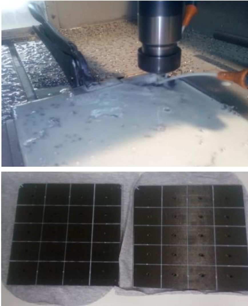
Εικόνα 43: Στην πάνω εικόνα φαίνεται η φρέζα κατά τη διαδικασία της διάτρησης. Το άσπρο υγρό είναι το σαπουνόλαδο που χρησιμοποιήθηκε. Στην κάτω εικόνα φαίνονται οι πλάκες μετά τη διαδικασία διάτρησης
