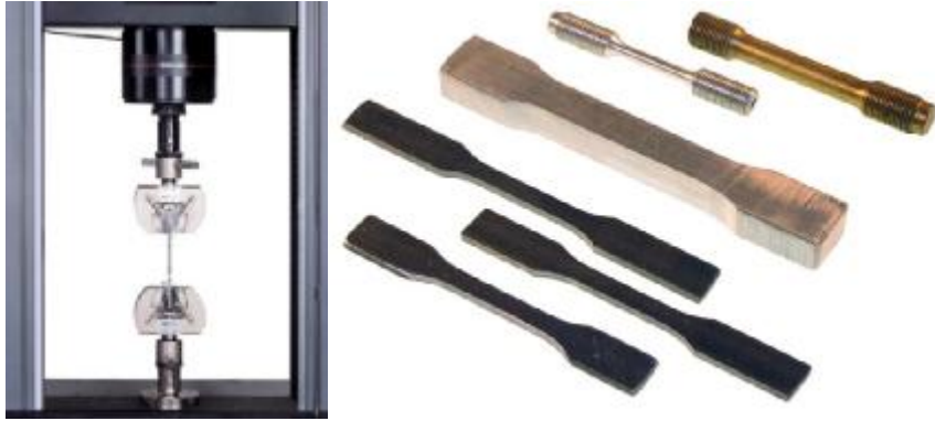
Εικόνα 24: Αριστερά φαίνεται μια τυπική διάταξη για τις δοκιμές εφελκυσμού, ενώ δεξιά διακρίνονται οι διαφορετικοί τύποι προτυποποιημένων δοκιμίων που χρησιμοποιούνται κατά τη δοκιμασία του εφελκυσμού.
