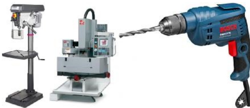
Εικόνα 13: Αριστερά φαίνεται ένα κολωνάτο δράπανο, στο κέντρο μια εργαλειομηχανή CNC και δεξιά ένα χειροτρύπανο.
