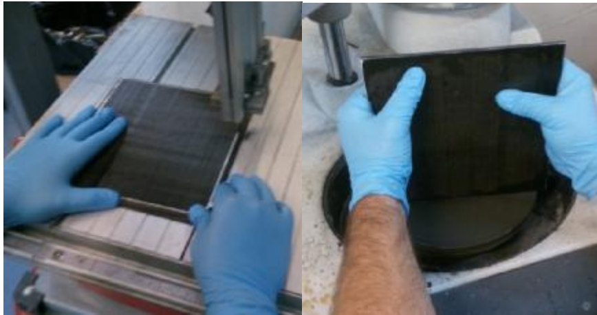
Εικόνα 41: Στην αριστερή εικόνα φαίνεται η διαδικασία φινιρίσματος στην κορδέλα, ενώ στην δεξιά εικόνα η διαδικασία λείανσης των ακμών των πλακών.
