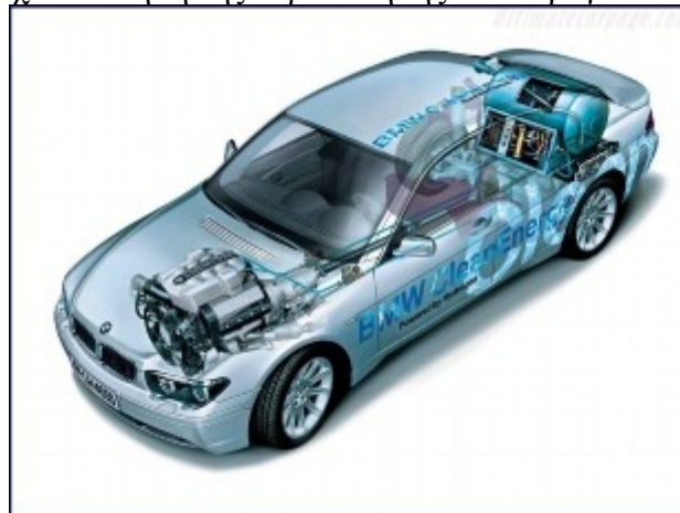
Εικόνα 46: Η διάταξη των μηχανολογικών συστημάτων της BMW E65 745h. Διακρίνεται ο κινητήρας, ο άξονας μετάδοσης της κίνησης και η δεξαμενή υδρογόνου που καταλαμβάνει μέρος του χώρου αποσκευών.
