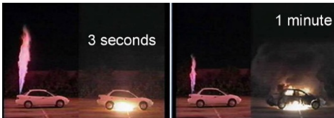
Εικόνα 10: Διαρροή καυσίμου υδρογόνου στο αριστερό όχημα (α) και βενζίνης στο δεξί όχημα (β) σε δύο στιγμιότυπα, μετά 3sec και μετά από 1min από έκρηξη.
