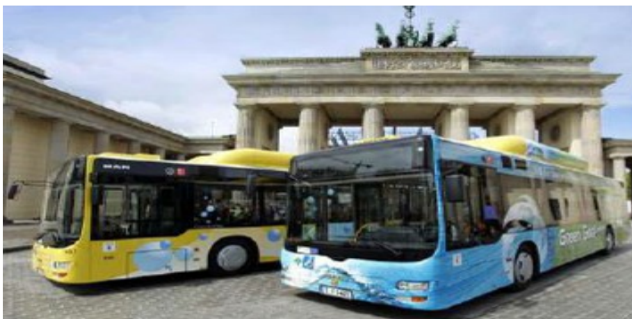
Εικόνα 7: Αστικά λεωφορεία MAN κινούμενα με ΜΕΚ υδρογόνου σε κυκλοφορία τον Ιούνιο του 2006 στο Βερολίνο ως τμήμα του ευρωπαϊκού προγράμματος HyFLEET [26].
