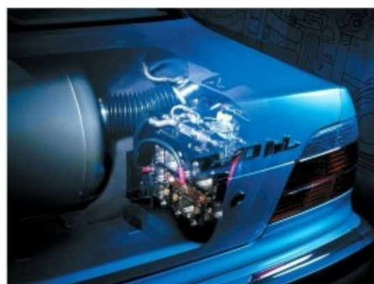
Εικόνα 43: Η χωροθέτηση του κινητήρα και των συστημάτων του αυτοκινήτου. Διακρίνεται η δεξαμενή καυσίμου στον χώρο αποσκευών και το ηλεκτρονικό κύκλωμα ελέγχου.
