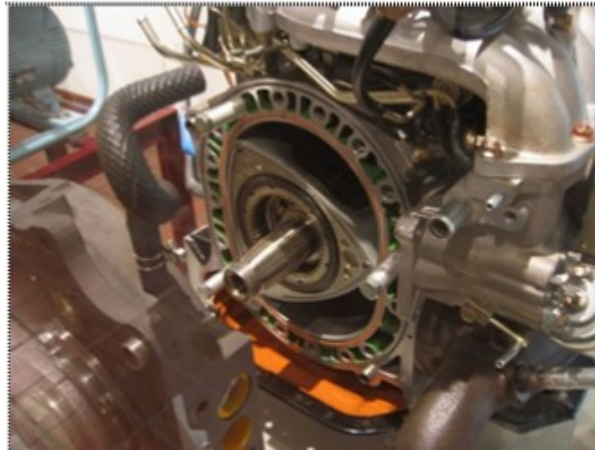
Εικόνα 37: Τα μηχανικά μέρη του περιστροφικού κινητήρα Wankel.
