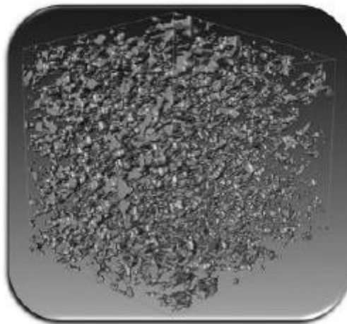
Εικόνα 2.14: FE-SEM νανοτομογραφία ενός πορώδους άνθρακα (PC-CTAB) (διαστάσεις: 500x500x700 nm). Οι γκρι περιοχές δείχνουν τα συμπαγή στοιχεία άνθρακα.
