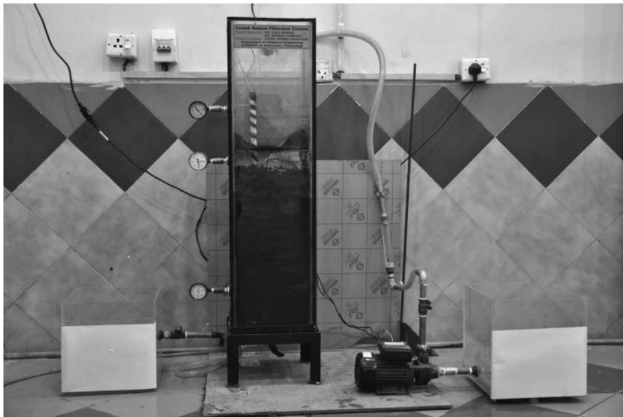
Σχήμα 1.1: Αντιδραστήρας τρίμματος καουτσούκ.
