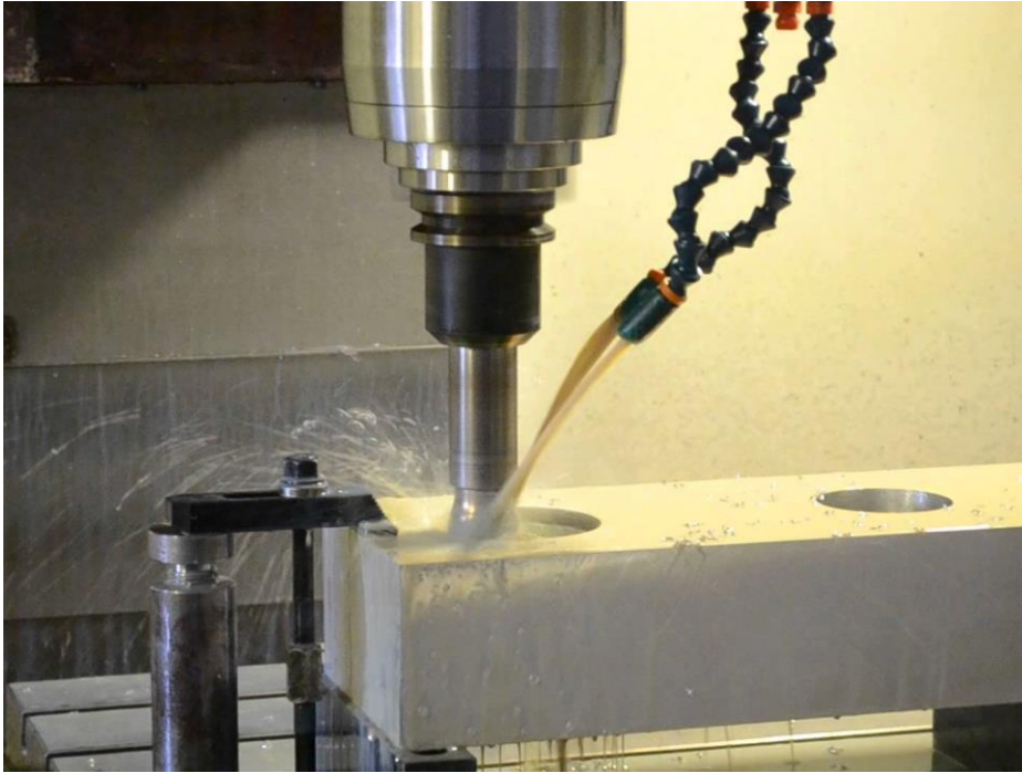
Εικόνα 4.5.2: Διάταξη κοπτικού – ψεκαστή υγρού κοπής σε λειτουργία
