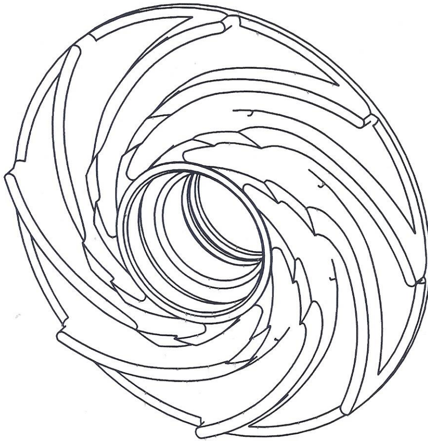
Εικόνα 2.2.1: Τρισδιάστατη απεικόνιση της φτερωτής αέρος
