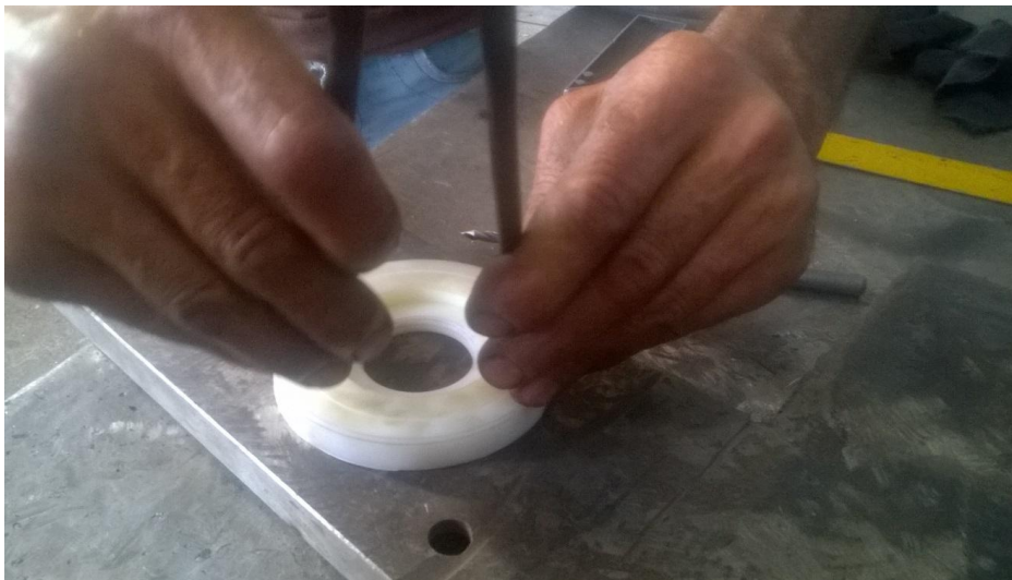
Εικόνα 3.12 Διαδικασία κατεργασίας φωλιάς στεγανοποίησης – κεντράρισμα για διάνοιξη οπών.
