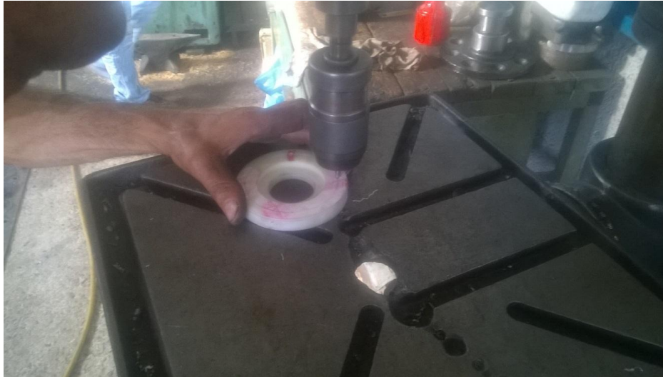
Εικόνα 3.13 Διαδικασία κατεργασίας φωλιάς στεγανοποίησης –διάνοιξη οπών.
