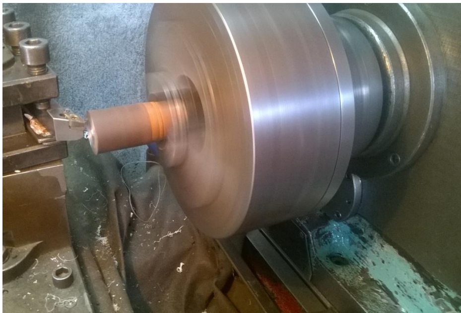
Εικόνα 3.30 Διαδικασία κατεργασίας συνδέσμου – καθάρισμα εξωτερικής επιφάνειας.
