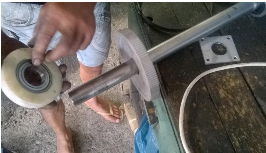
Εικόνα 3.19 Σύνδεση περιστρεφόμενου άξονα με φωλιές και τάπα δεξαμενής.
