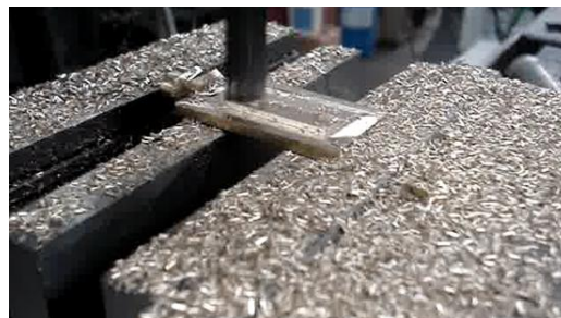
Εικόνα 3.25 Διαδικασία καταργασίας πτερυγίου φρεζάρισμα για τη διαμόρφωση της επίπεδης επιφάνειας του πτερυγίου.
