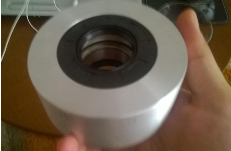
Εικόνα 3.8 Τελική εικόνα φωλιάς εμβαπτιζόμενου ρουλεμάν.
