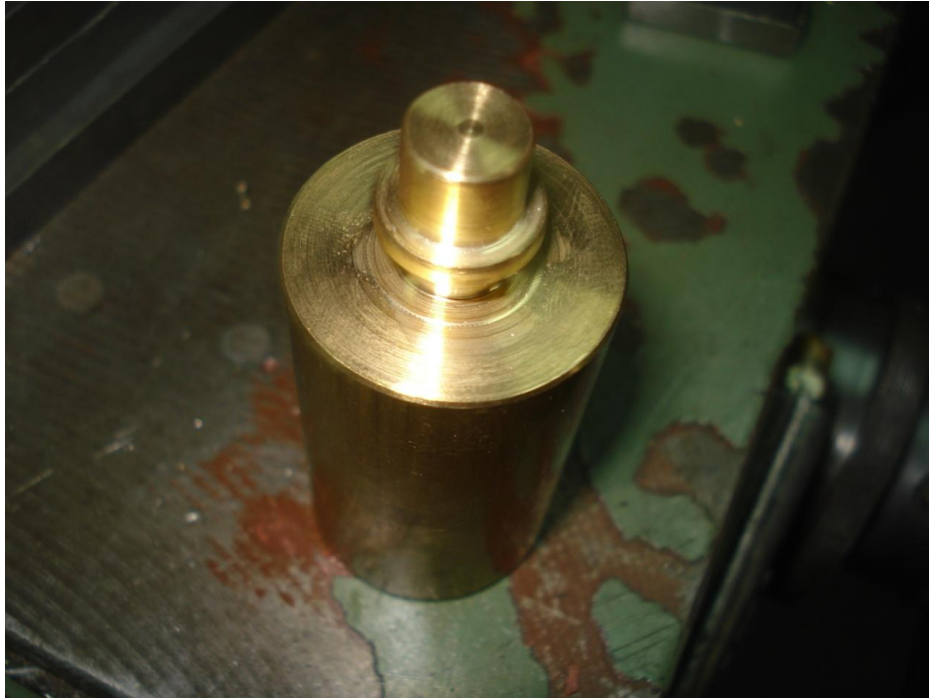
Εικόνα 3.24 Πτερύγιο έπειτα από το πρώτο στάδιο της καταργασίας.
