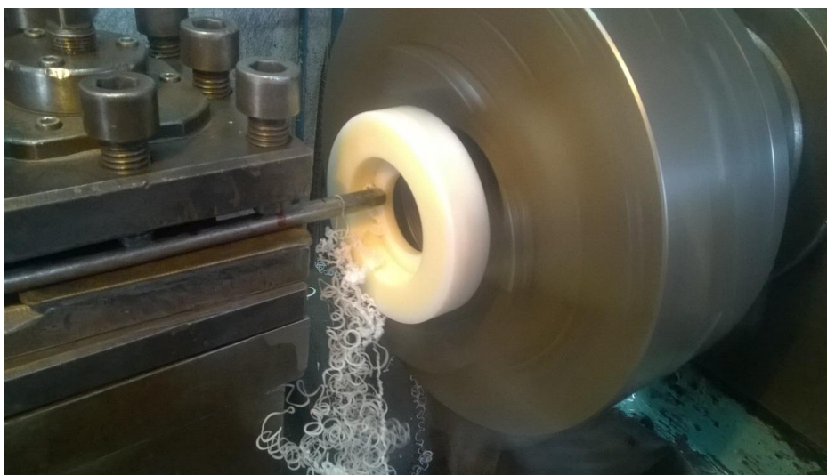
Εικόνα 3.15 Διαδικασία κατεργασίας φωλιάς εξωτερικού ρουλεμάν – διαμόρφωση εσωτερικής διαμέτρου.
