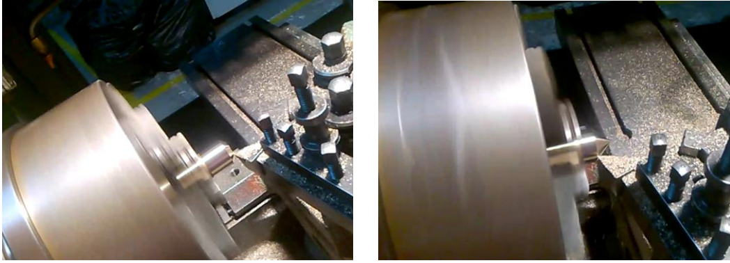
Εικόνα 3.27 Διαμόρφωση υδροδυναμικής κωνικής κεφαλής εμπρόσθιου τμήματος περωτής.
