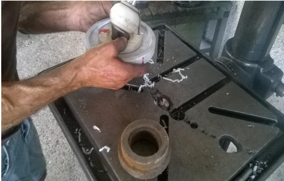
Εικόνα 3.17 Διαδικασία κατεργασίας φολιάς εξωτερικού ρουλεμάν – διάνοιξη σπών.
