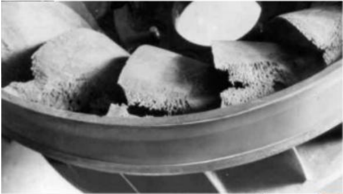
Εικόνα 1.1 Ορατές επιπτώσεις διάβρωσης σε περυγία λόγω σπηλαιώσης.
