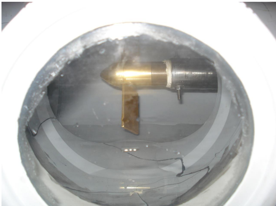
Εικόνα 3.32 Σύνδεση περωτής με περιστροφικό άξονα.
