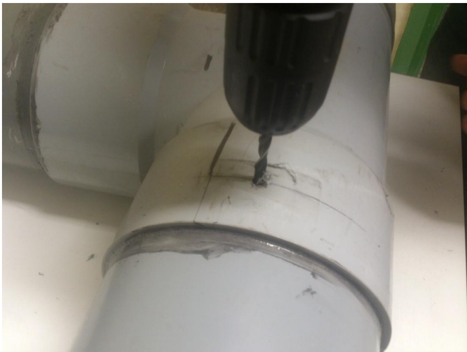
Εικόνα 3.9 Κατεργασία σύνδεσης φωλιάς εμβαπτιζόμενου ρουλεμάν με τη συσκευή.
