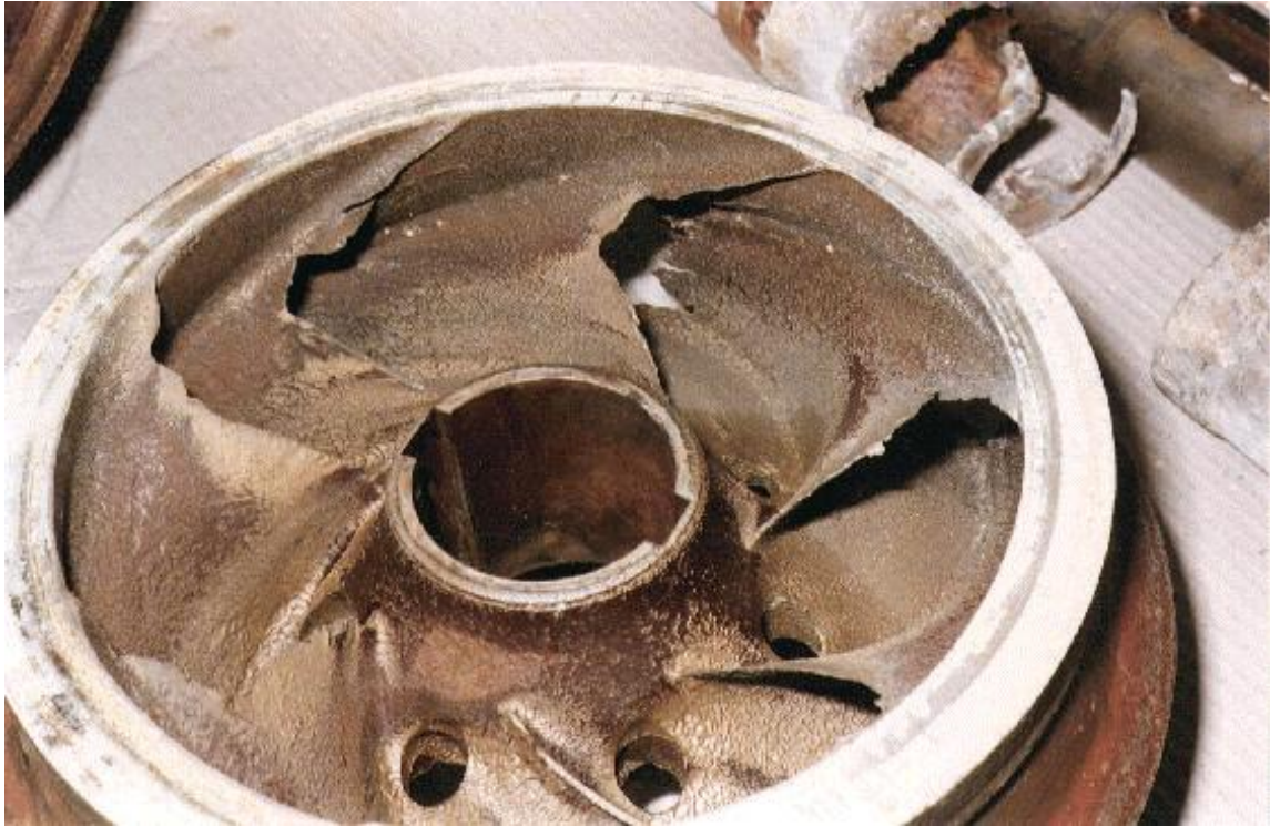
Εικόνα 1.2 Φθορές σε περωτή έπειτα από την ανάπτυξη του φαινομένου της σπηλαιώσης
