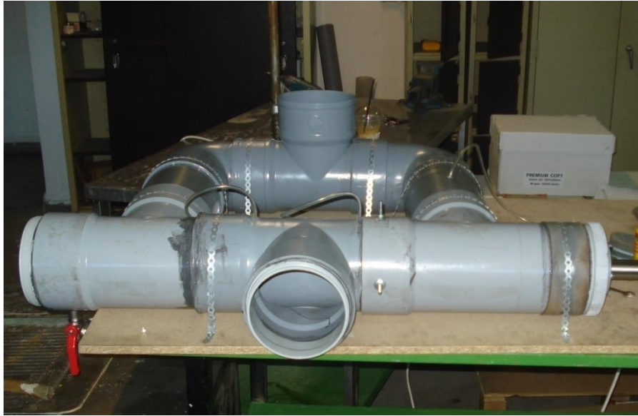
Εικόνα 3.5 Στερέωση συσκευής πάνω στη ξύλινη βάση με μεταλλικές ταινίες.
