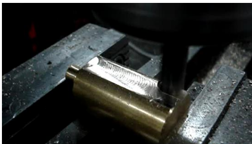
Εικόνα 3.25 Διαδικασία καταργασίας πτερυγίου φρεζάρισμα για τη διαμόρφωση της επίπεδης επιφάνειας του πτερυγίου.
