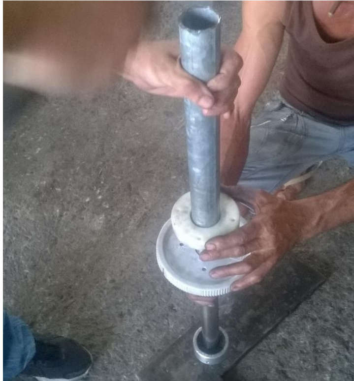
Εικόνα 3.20 Διαδικασία περάσματος φωλιάς στον άξονα με σφυρί και μεγαλύτερης διαμέτρου σωλήνα.
