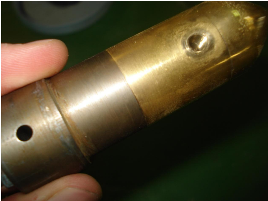
Εικόνα 3.28 Σύνδεση επιμέρους τμημάτων του άξονα πτερωτής.
