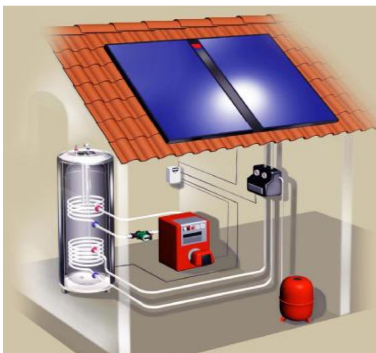
Εικόνα 26: Κεντρικό ηλιακό σύστημα
