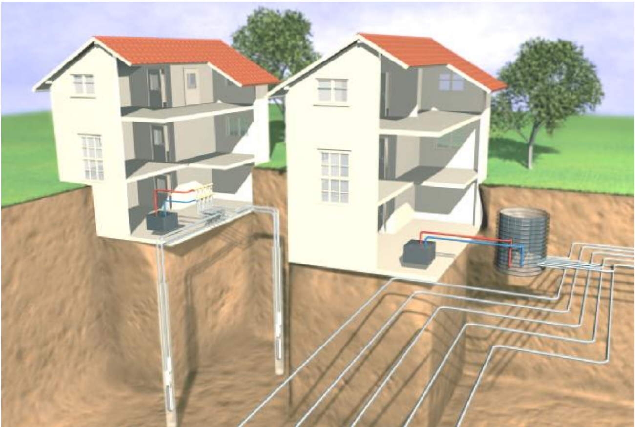
Εικόνα 32: Γεωθερμικό σύστημα κλειστού κυκλώματος
